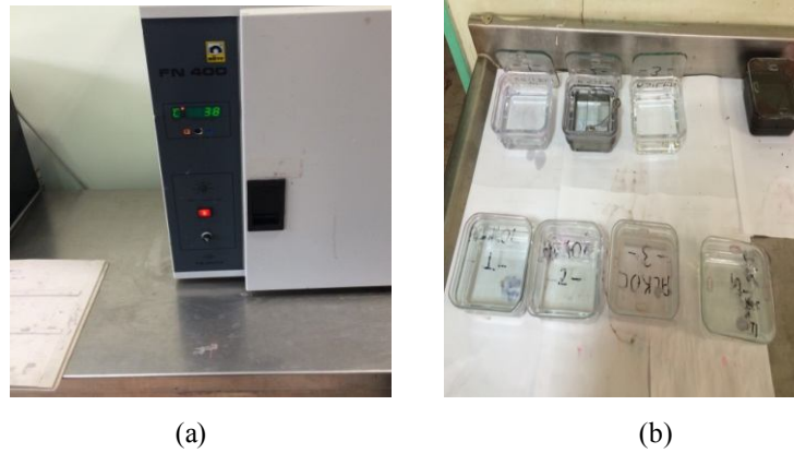
Şekil 2.10. Lameller üzerindeki parafinlerin yok edilmesi (a) Preparatların ısıtılması (b) Preparatların ksilole ve alkol çeşitlerine bırakılması
