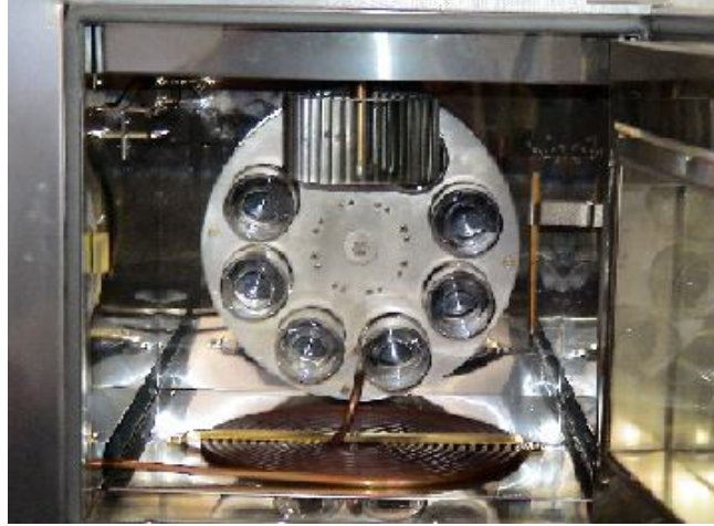
Şekil 3.10. Dönel ince film halinde ısıtma deney aletine şişelerin yerleştirilmesi
