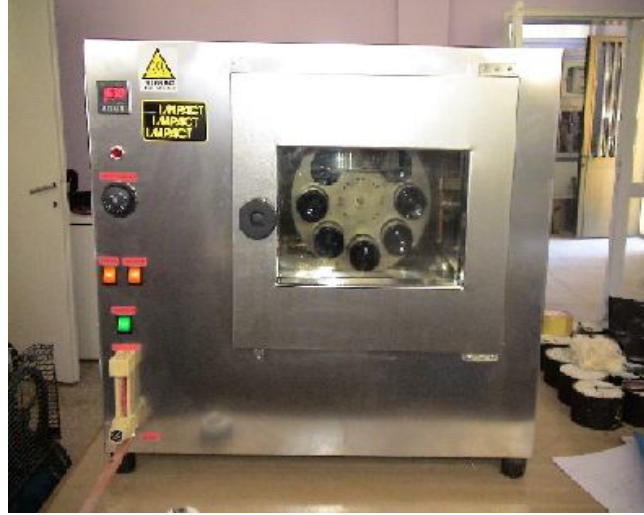
Şekil 3.11. Dönel ince film halinde ısıtma deneyinin yapılışı
