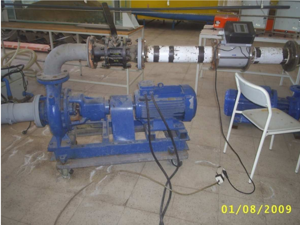
c) Deneylerde kullanılan akım kontrol vanası ve dijital debi ölçme aleti
