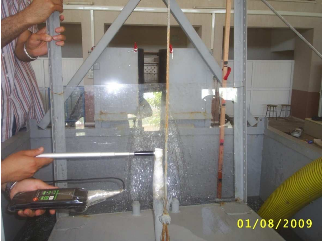
f) Anemometre ile hava debisinin ölçülmesi
