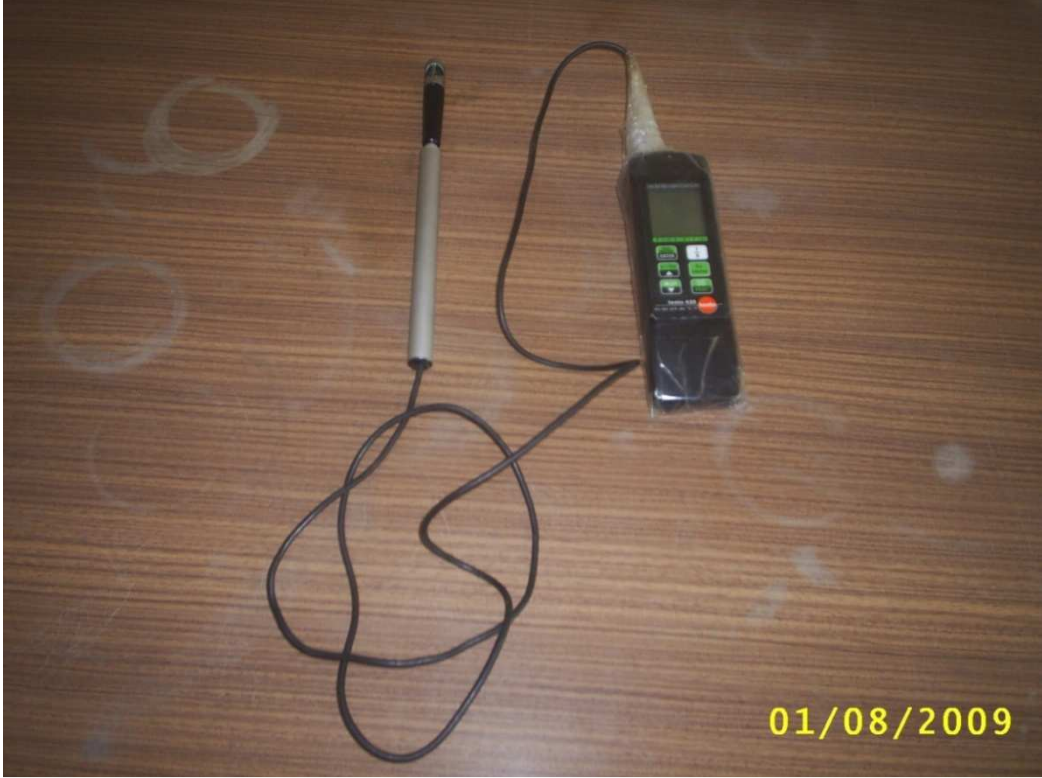
d) Deneylerde kullanılan dijital hava debisi ölçme aleti (anemometre)
