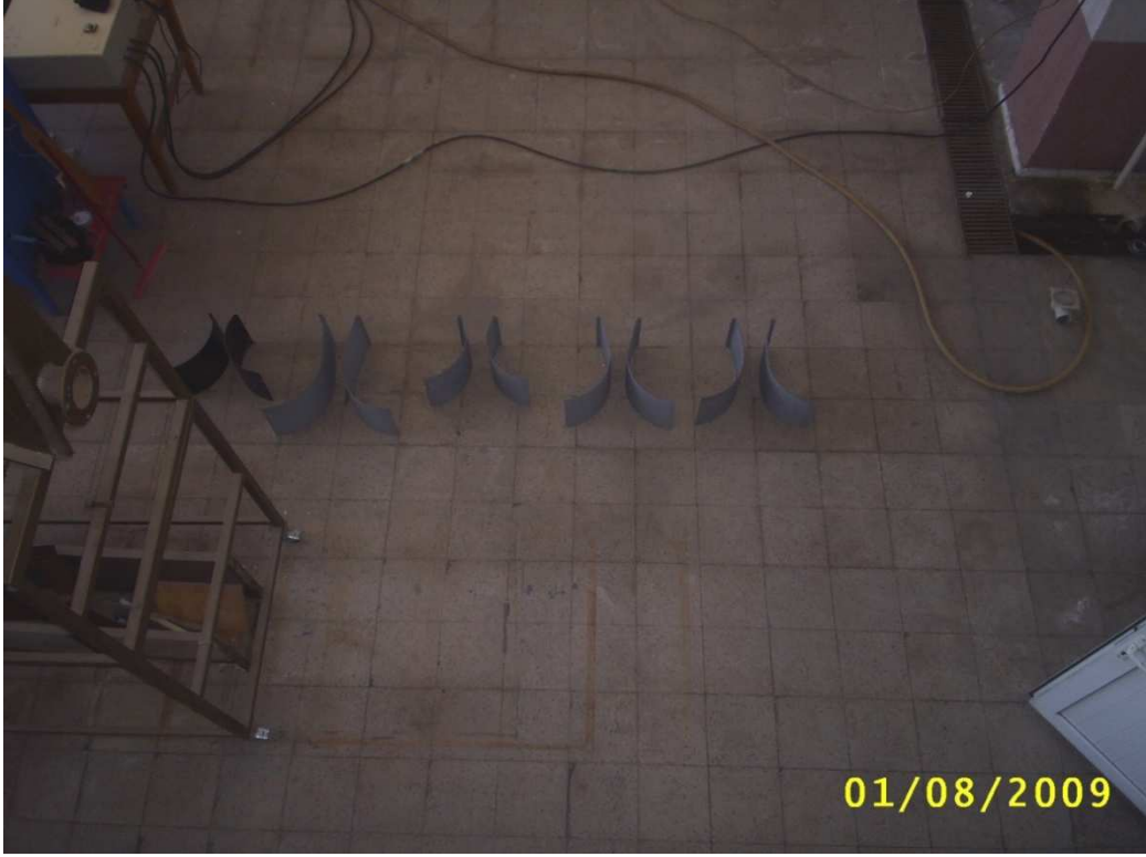
b) Deneylerde kullanılan farklı tip venturi savaklar
