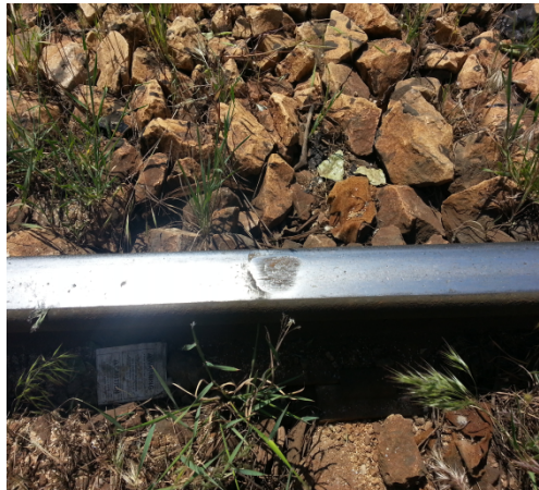
Şekil 2.3. Raylarda apletlik arızası
