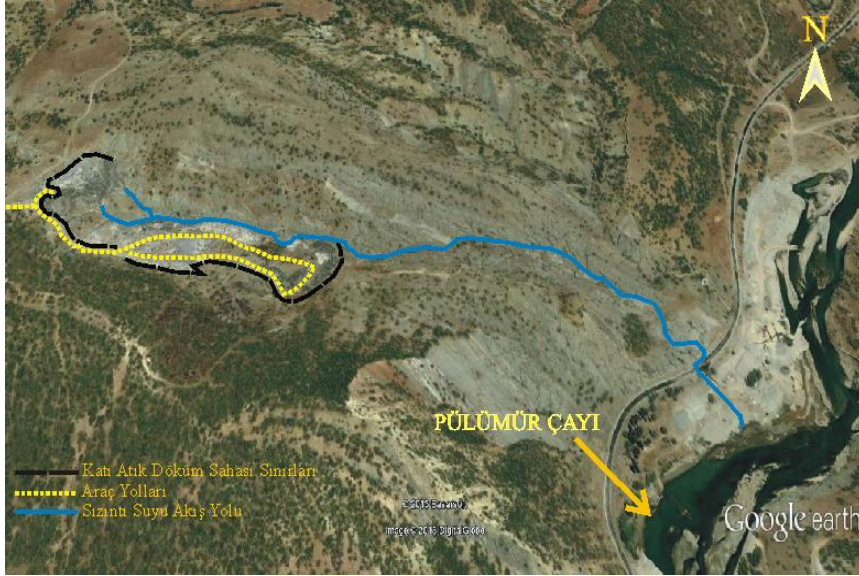
Şekil 6.38. Tunceli İli Düzensiz Katı Atık Depolama Sahasından Kaynaklanan Katı Atık Sızıntı Suları
