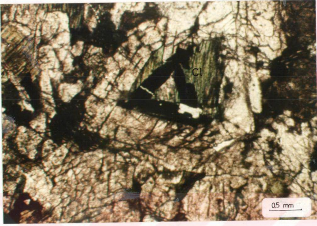
Şekil 4.5. Şekil 4.4'ün tek nikoldeki görünüşü. Klorit (Cl), TNx32.
