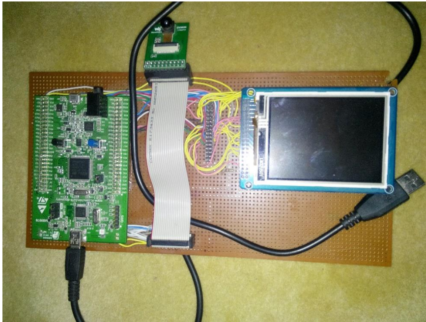
Şekil 3.11. OV9655 kamera modülü kullanılarak elde edilen prototip kamera
