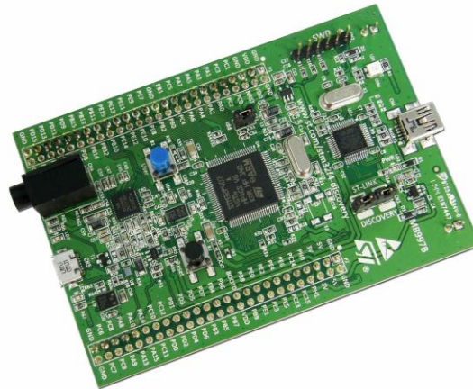
Şekil 3.7. STM32F407 işlemci tabanlı geliştirme kartı
