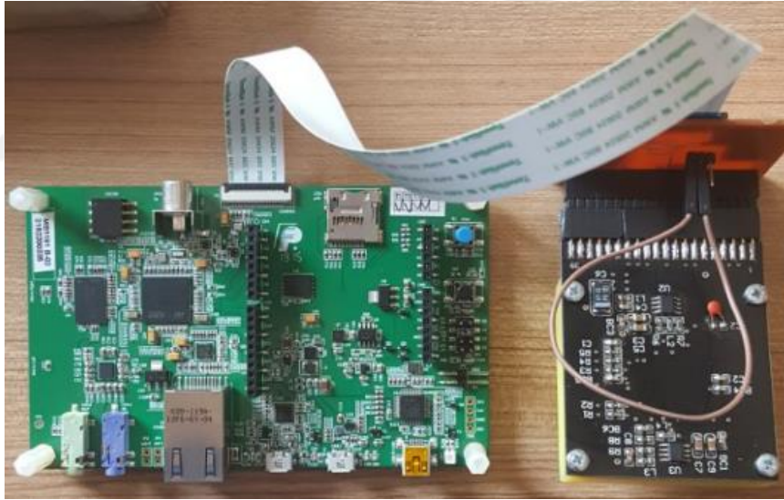
Şekil 3.25. Kamera modülü ve STM32F746 arka yüz
