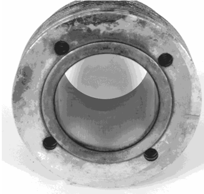
Şekil 4.26. Türbülatorlü Çalışma Sonunda Gömlek.
