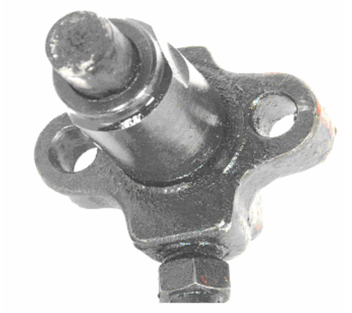
Şekil 4.28. Türbülatorlü Çalışma Sonunda Enjektör.
