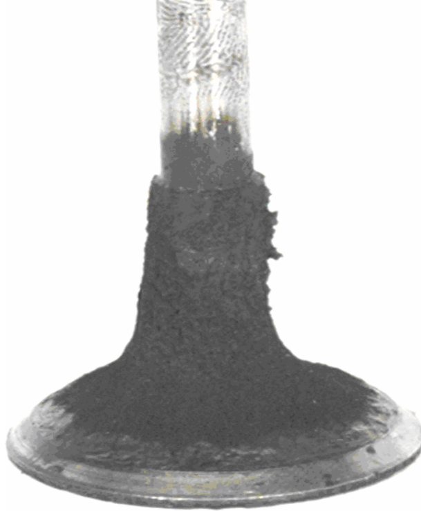
Şekil 4.22. Türbülatorlü Çalışma Sonunda Ekzos Supabı.
