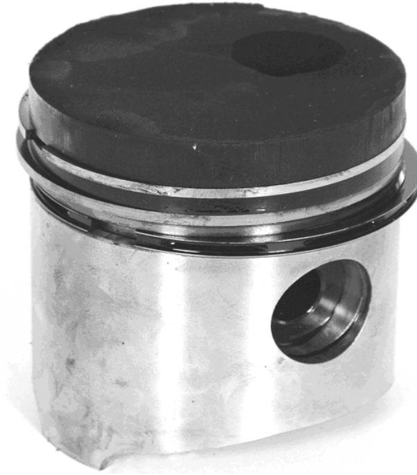
Şekil 4.20. Türbülatoörlü Çalışma Sonunda Pistonun Görünüşü.
