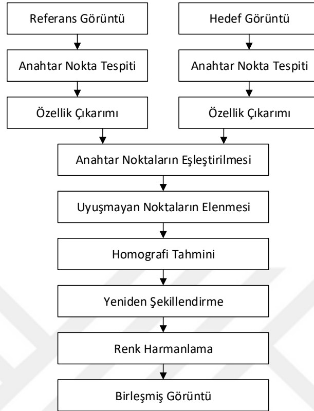
Şekil 4.2. Özellik tabanlı görüntü mozaikleme adımları [25].
