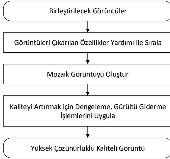
Şekil 1.1. Literatürde yer alan özellik tabanlı mozaikleme yönteminin genel adımları [29].
