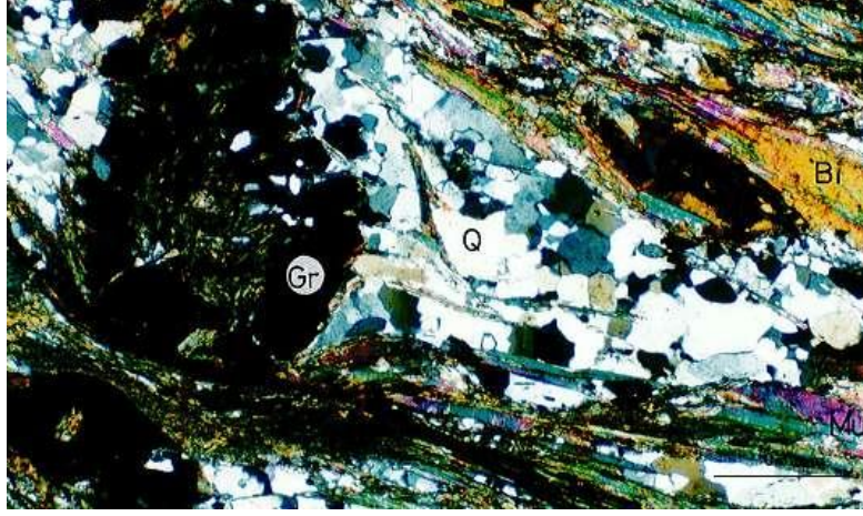
Şekil 5.12. Kapanım minerallerinin yoğun olduğu GR2 nolu örnek
