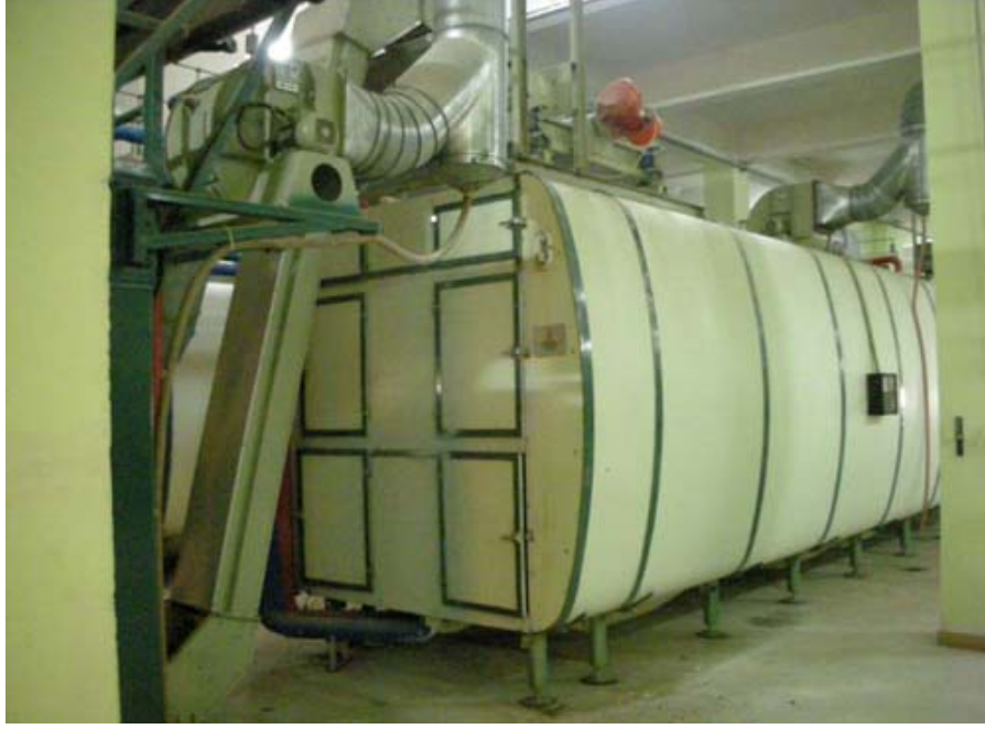
Şekil 4.1. Makarna kurutmada kullanılan endüstriyel gıda kurutucusu
