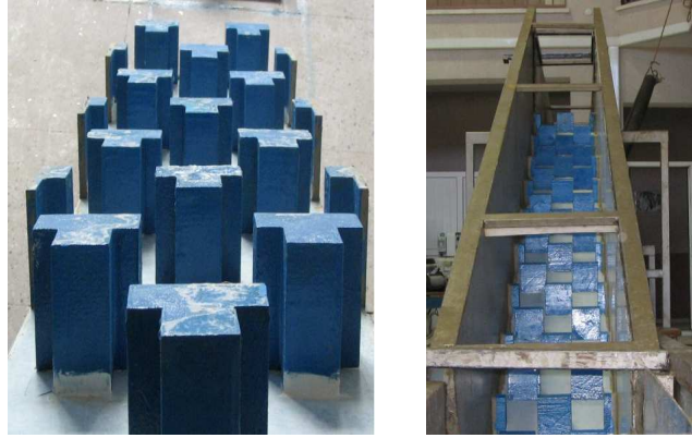
Şekil 4.4 Enerji kırıcı blokların şüt kanalındaki görünümü
