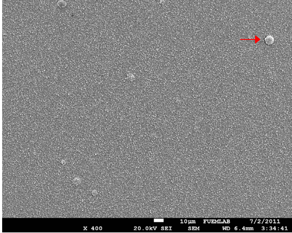
Şekil 4.11. T1 numunesinde film yüzeyindeki büyük topakları gösteren SEM görüntüsü
