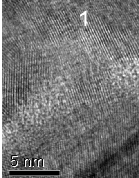
Şekil 4.44. Düzlem-görüntü T2 numunesinin aralarında yönelim ilişkisi bulunmayan tanelerin HRTEM görüntüsü
