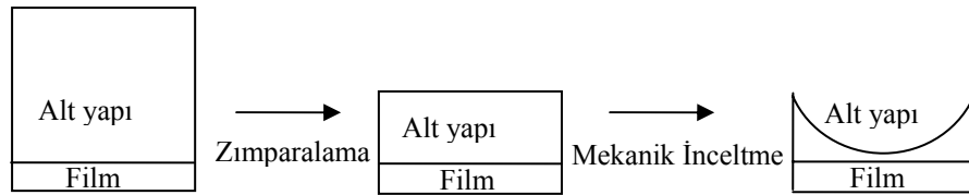
Şekil 3.2. Sırasıyla alt yapının zımparalanarak inceltilmesi ve mekanik inceltme cihazı kullanılarak orta kısmının oyulması
