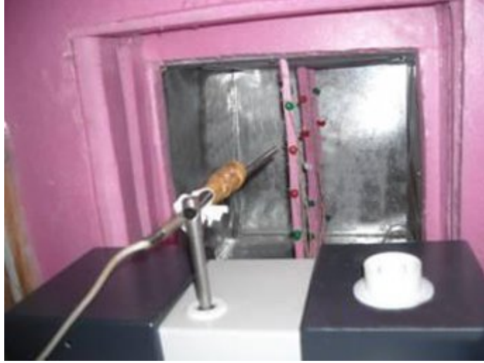
Şekil 2.9. Hız probunun konumlandırılması
