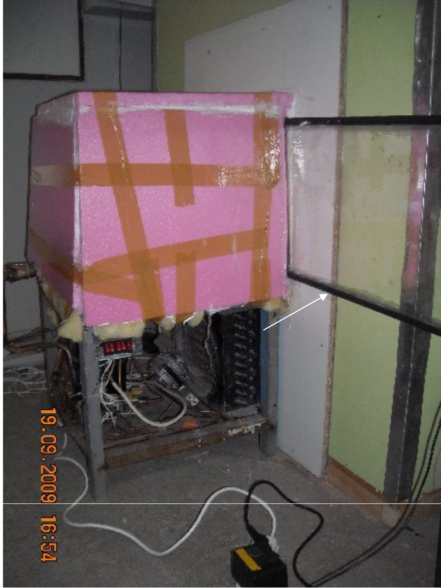
Şekil 2.10. Kübik boşluğun sürgülü kapısı
