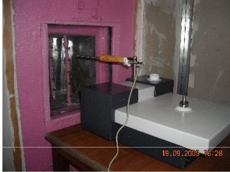
Şekil 2.3. Hız probunun hareket etmesini sağlayan robot
