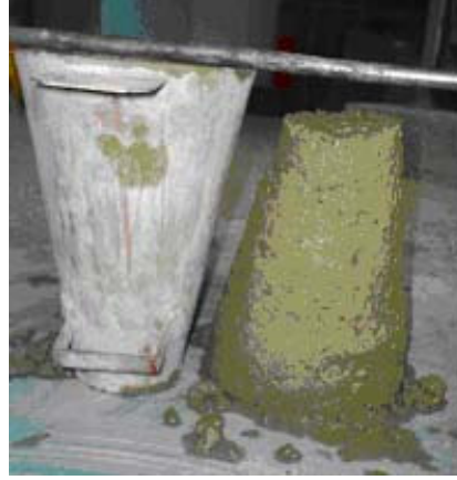
Şekil 5.2 Kontrol betonu için çökme deneyi
