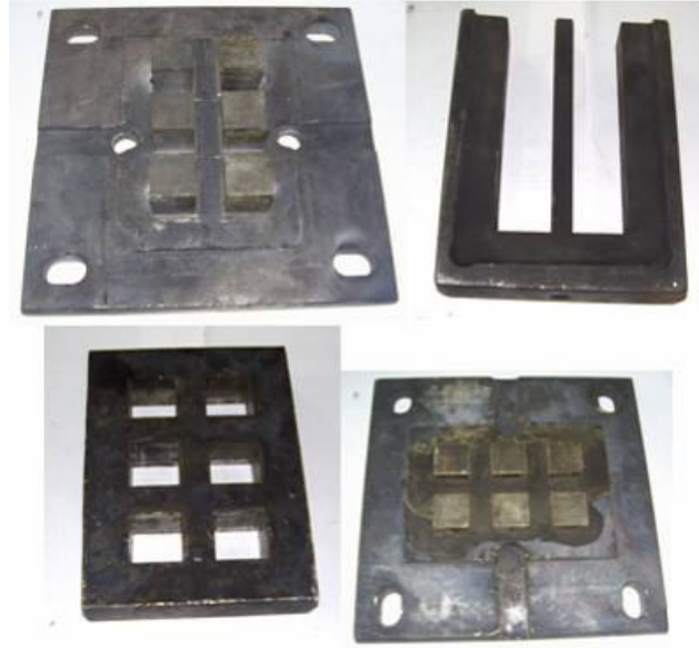
Şekil 7.22 Deney numunelerinin üretildiği sıcak presleme kalıbı
