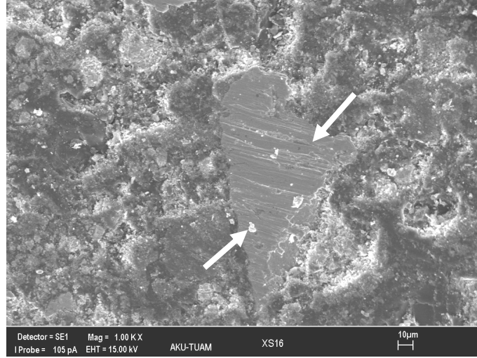
Şekil 8.106 XS-16 kodlu numunenin sürtünme yüzeyi SEM resmi
