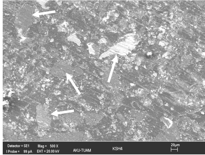
Şekil 8.80 KSH-4 kodlu numunenin sürtünme yüzeyi SEM resmi
