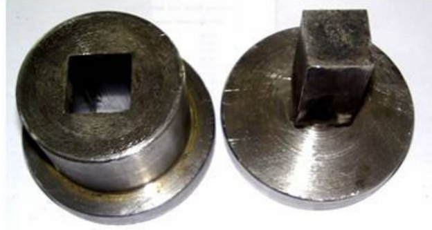
Şekil 7.20 Deney numunelerinin üretildiği soğuk presleme kalıbının görünüşü
