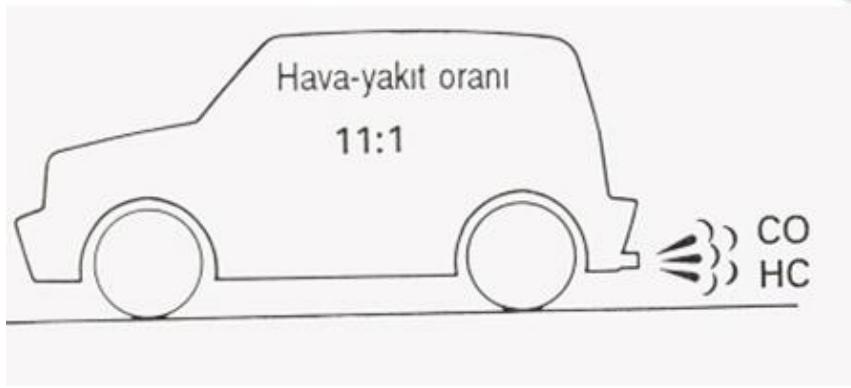
Şekil 1.7. Motorun rölantide çalışması durumu
