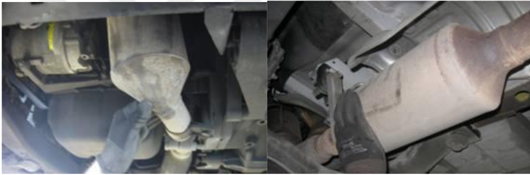
Şekil 3.5 Katalitik konvertör araç üzerinde bağlantı yeri
