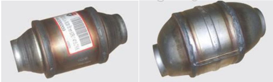
Şekil 3.3. Eleman olarak değiştirilen ve bağlantı flanşlarına kaynak ile bağlanan Katalitik Konvertörler
