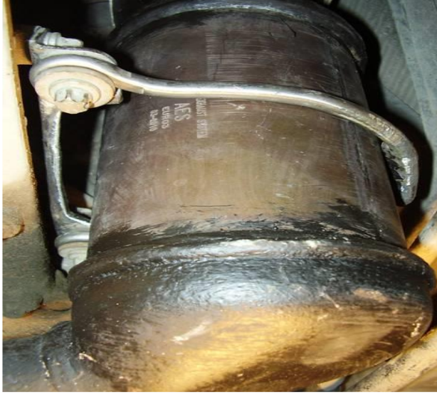
Şekil 3.4 Üretici firma bilgileri ve emisyon normu işaretlemeleri
