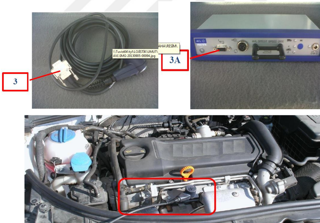
Şekil 5.6. Devir sensörünün motora bağlanma görüntüsü
