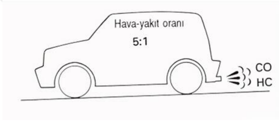
Şekil 1.6. Motorun ilk ısınması durumu
