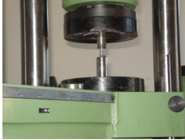
Şekil 5.1. Tozların preslenmesi işlemi
