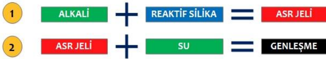
Şekil 2.8. Betonda ASR'ye bağlı genleşme faktörleri (URL-6,2018).
