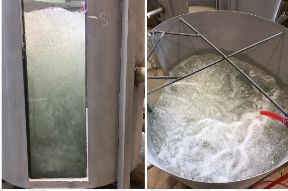
Şekil 4.47. HL=15 cm hol boyu, d=35 mm hol çapı ve K=%40 konduit açıklığı ile yapılan deney sonucu meydana gelen kabarcıklar
