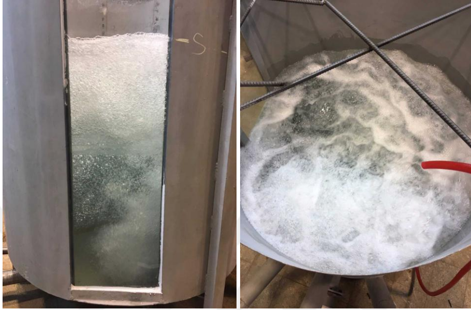
Şekil 4.32. HL=20 cm hol boyu, d=35 mm hol çapı ve K=%10 konduit açıklığı ile yapılan deney sonucu meydana gelen kabarcıklar
