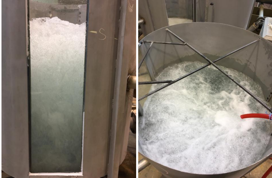
Şekil 4.38. HL=15 cm hol boyu, d=35 mm hol çapı ve K=%30 konduit açıklığı ile yapılan deney sonucu meydana gelen kabarcıklar
