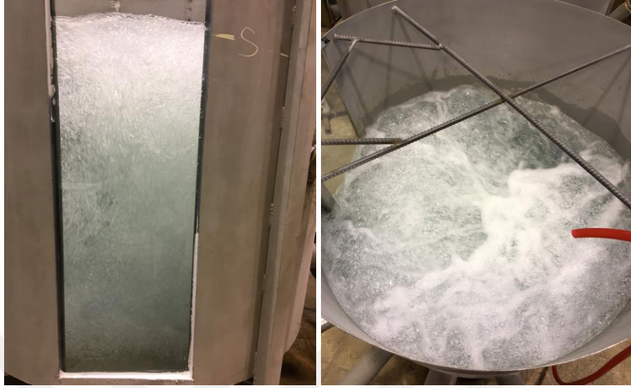
Şekil 4.41. HL=20 cm hol boyu, d=35 mm hol çapı ve K=%30 konduit açıklığı ile yapılan deney sonucu meydana gelen kabarcıklar
