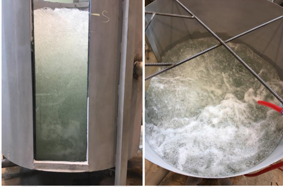
Şekil 4.45. HL=15 cm hol boyu, d=15 mm hol çapı ve K=%40 konduit açıklığı ile yapılan deney sonucu meydana gelen kabarcıklar
