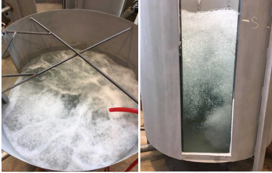
Şekil 4.28. HL=15 cm hol boyu, d=30 mm hol çapı ve K=%10 konduit açıklığı ile yapılan deney sonucu meydana gelen kabarcıklar
