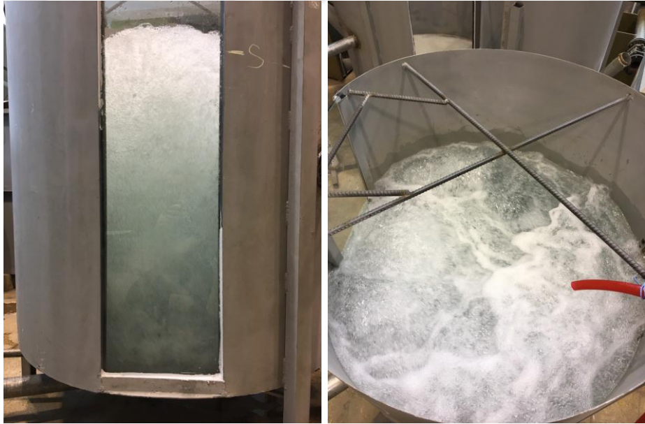
Şekil 4.34. HL=10 cm hol boyu, d=30 mm hol çapı ve K=%30 konduit açıklığı ile yapılan deney sonucu meydana gelen kabarcıklar
