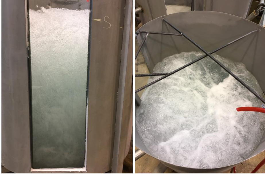
Şekil 4.36. HL=15 cm hol boyu, d=15 mm hol çapı ve K=%30 konduit açıklığı ile yapılan deney sonucu meydana gelen kabarcıklar
