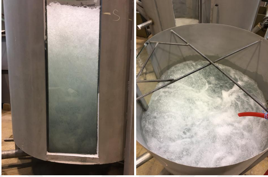
Şekil 4.33. HL=10 cm hol boyu, d=15 mm hol çapı ve K=%30 konduit açıklığı ile yapılan deney sonucu meydana gelen kabarcıklar
