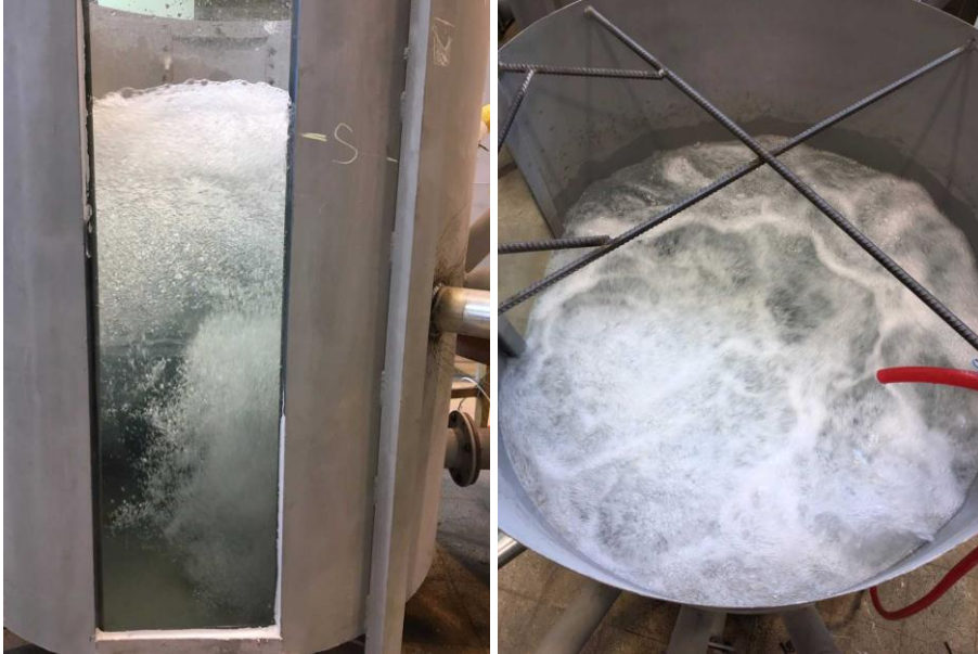
Şekil 4.26. HL=10 cm hol boyu, d=35 mm hol çapı ve K=%10 konduit açıklığı ile yapılan deney sonucu meydana gelen kabarcıklar
