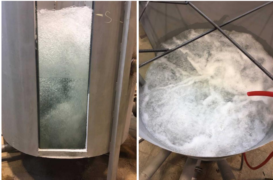
Şekil 4.31. HL=20 cm hol boyu, d=30 mm hol çapı ve K=%10 konduit açıklığı ile yapılan deney sonucu meydana gelen kabarcıklar
