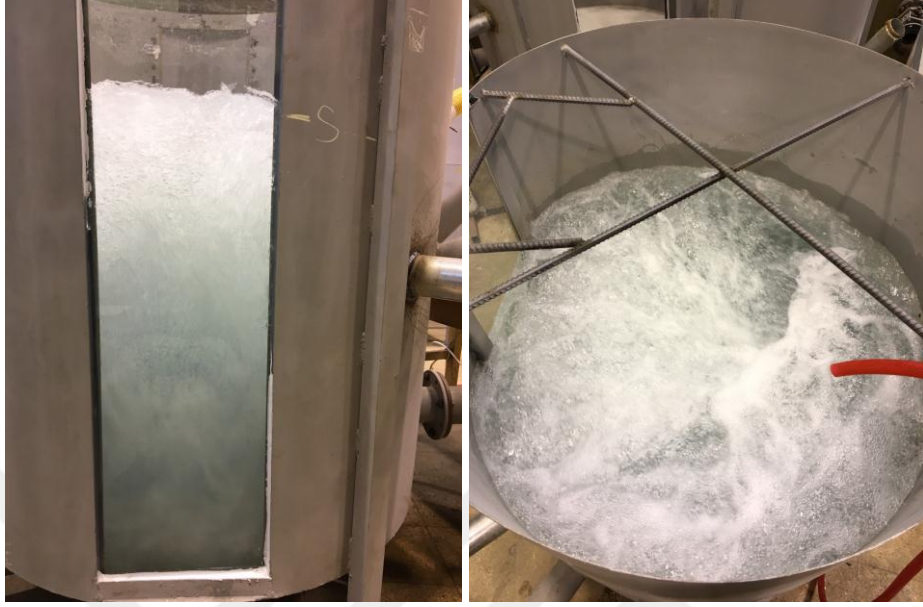
Şekil 4.39. HL=20 cm hol boyu, d=15 mm hol çapı ve K=%30 konduit açıklığı ile yapılan deney sonucu meydana gelen kabarcıklar
