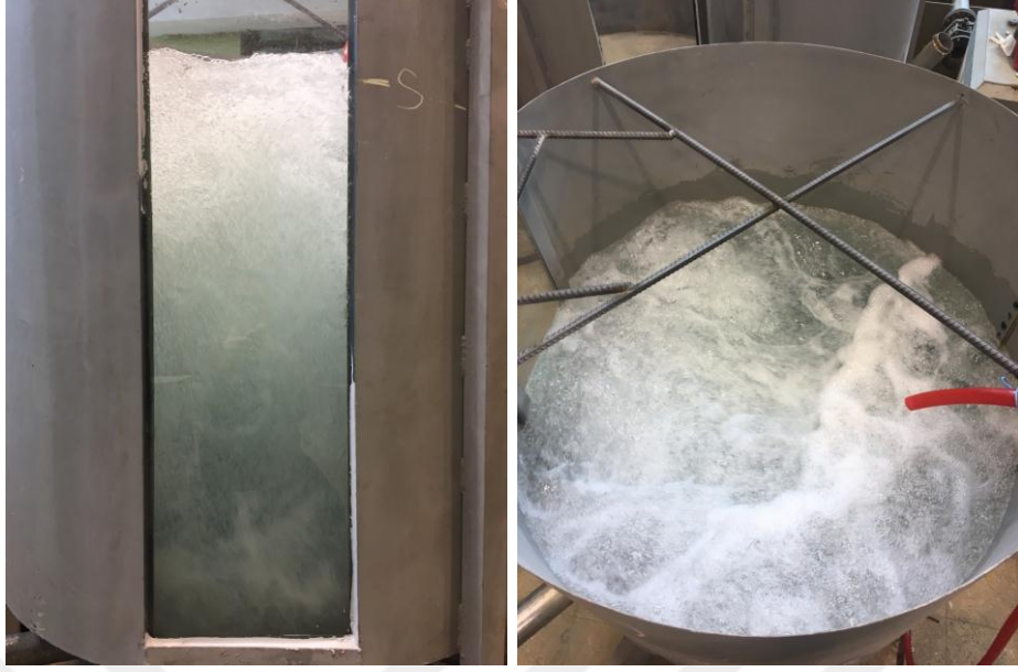
Şekil 4.35. HL=10 cm hol boyu, d=35 mm hol çapı ve K=%30 konduit açıklığı ile yapılan deney sonucu meydana gelen kabarcıklar
