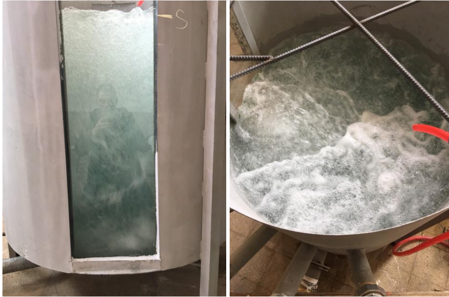
Şekil 4.44. HL=10 cm hol boyu, d=35 mm hol çapı ve K=%40 konduit açıklığı ile yapılan deney sonucu meydana gelen kabarcıklar
