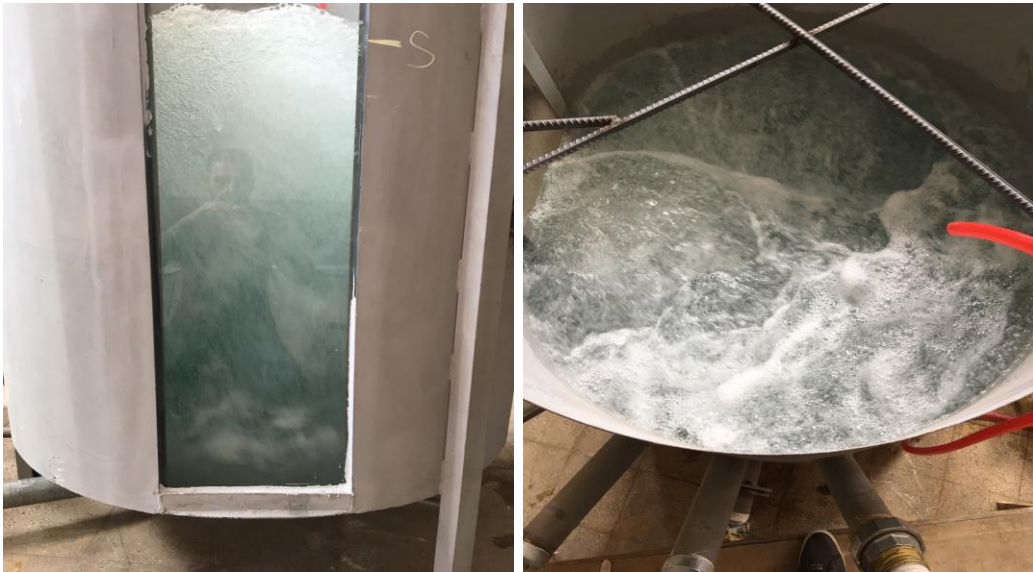
Şekil 4.42. HL=10 cm hol boyu, d=15 mm hol çapı ve K=%40 konduit açıklığı ile yapılan deney sonucu meydana gelen kabarcıklar
