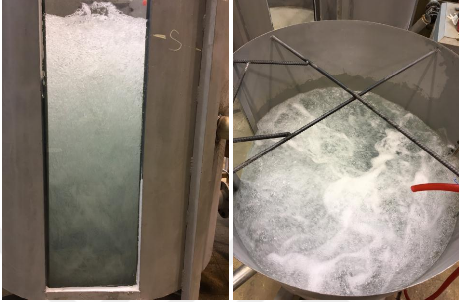
Şekil 4.37. HL=15 cm hol boyu, d=30 mm hol çapı ve K=%30 konduit açıklığı ile yapılan deney sonucu meydana gelen kabarcıklar
