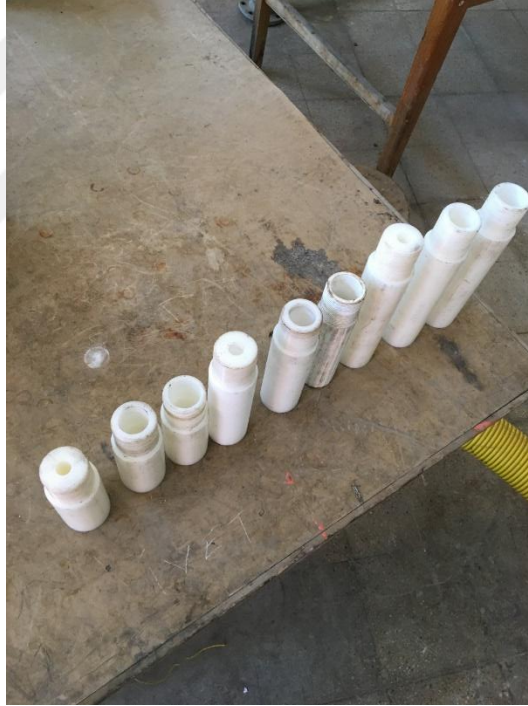
Şekil 4.13. Farklı uzunluk ve çapdaki polyemit türevli holler
