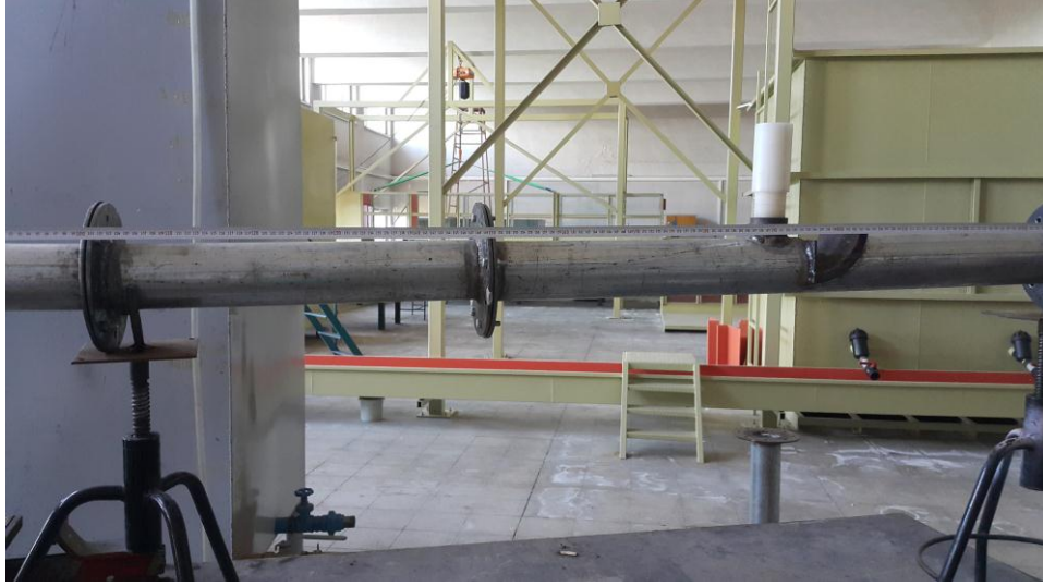
Şekil 4.14. Yüksek basınçlı konduite hava holü eklenmesi
