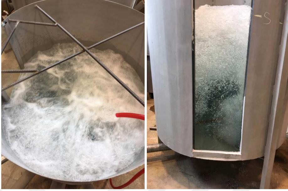
Şekil 4.25. HL=10 cm hol boyu, d=30 mm hol çapı ve K=%10 konduit açıklığı ile yapılan deney sonucu meydana gelen kabarcıklar
