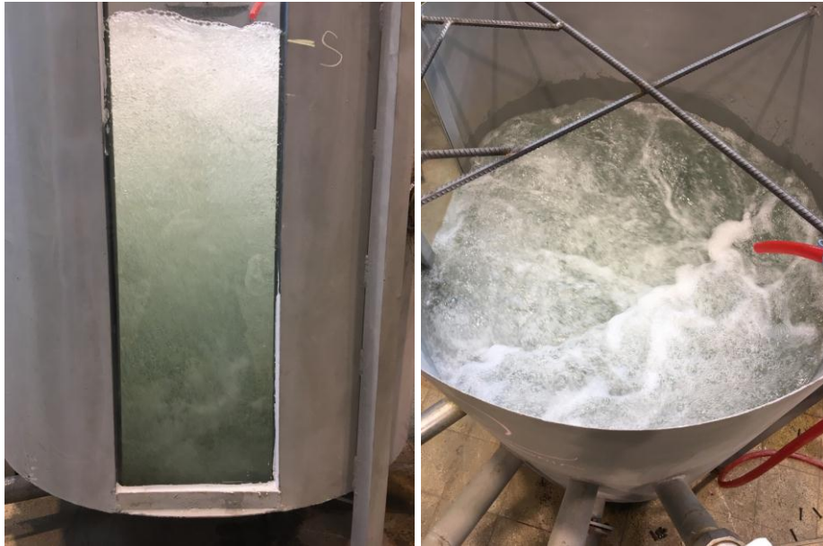
Şekil 4.46. HL=15 cm hol boyu, d=30 mm hol çapı ve K=%40 konduit açıklığı ile yapılan deney sonucu meydana gelen kabarcıklar
