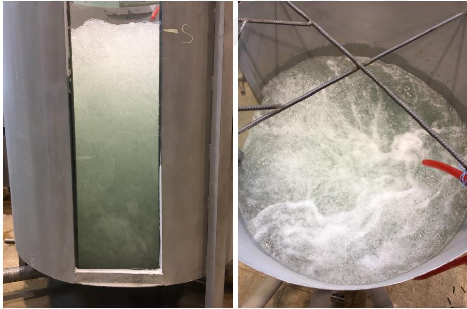
Şekil 4.48. HL=20 cm hol boyu, d=15 mm hol çapı ve K=%40 konduit açıklığı ile yapılan deney sonucu meydana gelen kabarcıklar
