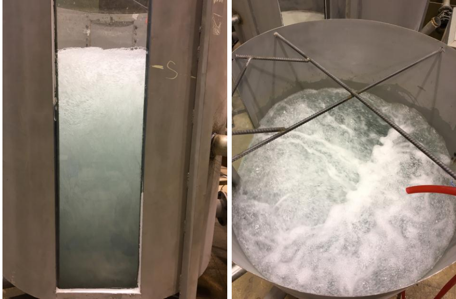
Şekil 4.40. HL=20 cm hol boyu, d=30 mm hol çapı ve K=%30 konduit açıklığı ile yapılan deney sonucu meydana gelen kabarcıklar
