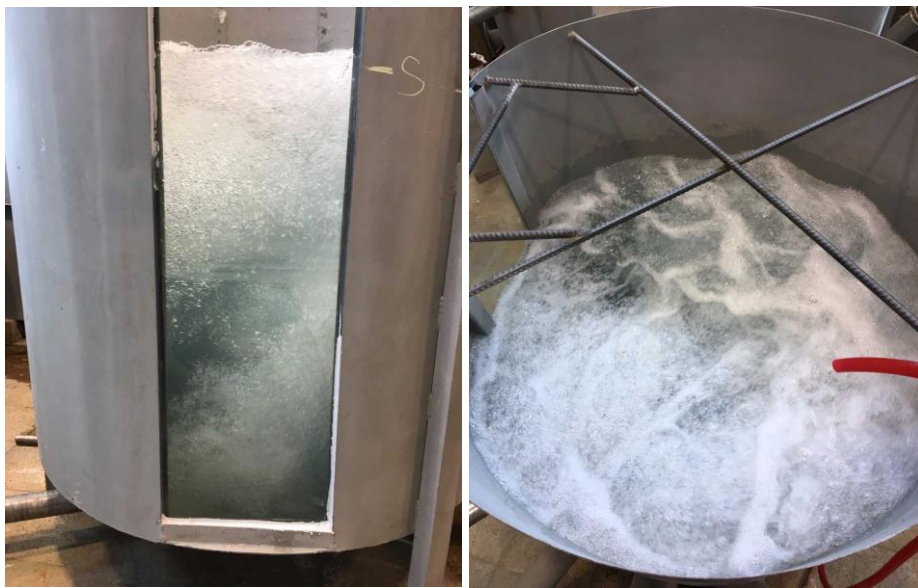
Şekil 4.29. HL=15 cm hol boyu, d=35 mm hol çapı ve K=%10 konduit açıklığı ile yapılan deney sonucu meydana gelen kabarcıklar
