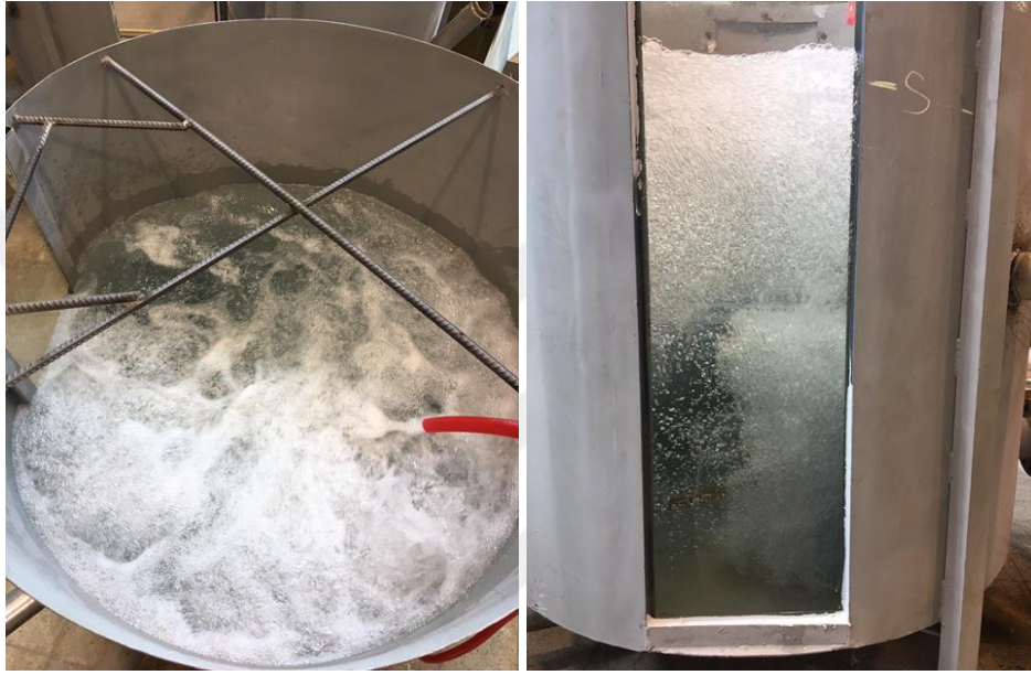
Şekil 4.24. HL=10 cm hol boyu, d=15 mm hol çapı ve K=%10 konduit açıklığı ile yapılan deney sonucu meydana gelen kabarcıklar
