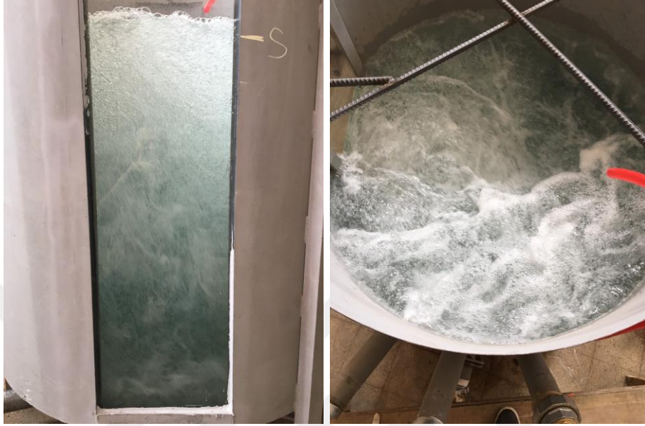
Şekil 4.43. HL=10 cm hol boyu, d=30 mm hol çapı ve K=%40 konduit açıklığı ile yapılan deney sonucu meydana gelen kabarcıklar
