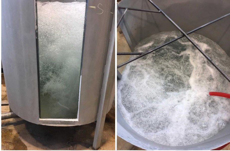
Şekil 4.30. HL=20 cm hol boyu, d=15 mm hol çapı ve K=%10 konduit açıklığı ile yapılan deney sonucu meydana gelen kabarcıklar
