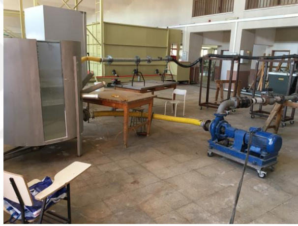
Şekil 4.10. Kondüitle desteklenmiş flotasyon hücresi
