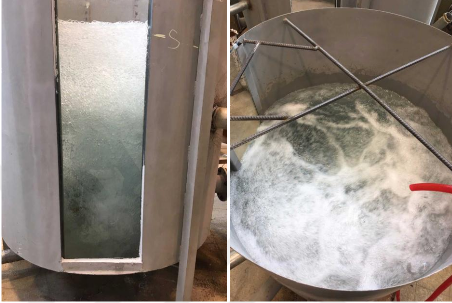
Şekil 4.27. HL=15 cm hol boyu, d=15 mm hol çapı ve K=%10 konduit açıklığı ile yapılan deney sonucu meydana gelen kabarcıklar
