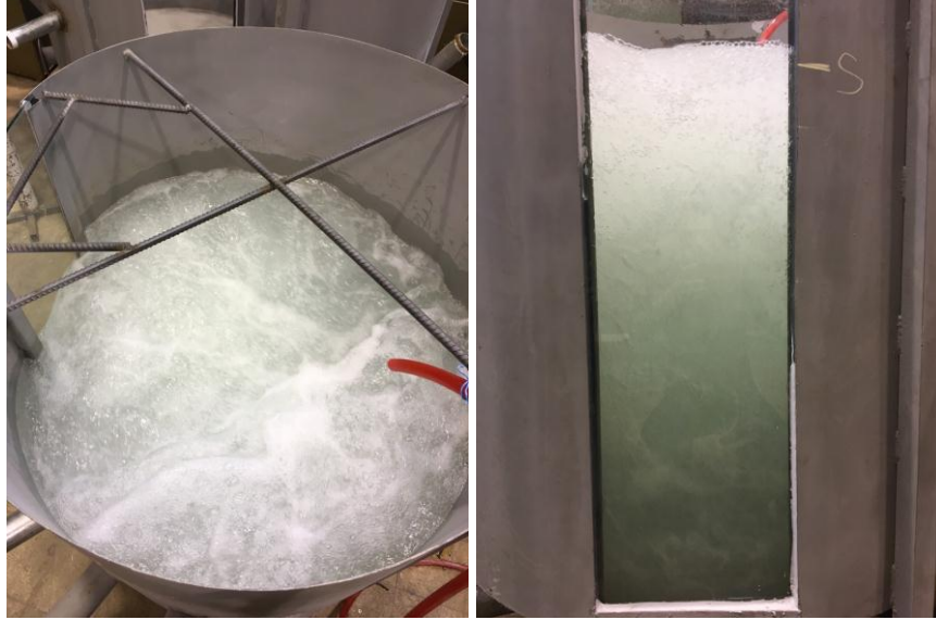
Şekil 4.50. HL=20 cm hol boyu, d=35 mm hol çapı ve K=%40 konduit açıklığı ile yapılan deney sonucu meydana gelen kabarcıklar
