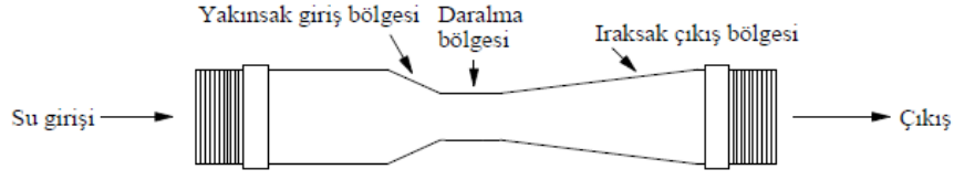
Şekil 3.6. Bir venturi aygıtının görünümü (Özkan, 2005).
