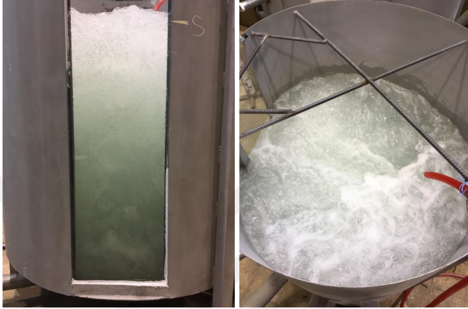
Şekil 4.49. HL=20 cm hol boyu, d=30 mm hol çapı ve K=%40 konduit açıklığı ile yapılan deney sonucu meydana gelen kabarcıklar
