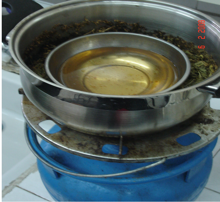
Şekil 11: O. vulgare subsp. gracile 'nin su ve yağının elde edilmesinde kullanılan preparatif düzenek.
