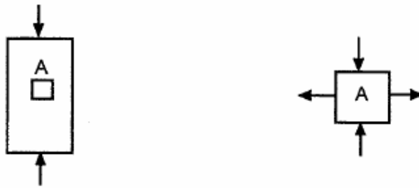
Şekil 10.3. Basınç yükü nedeniyle oluşan çekme kuvveti
