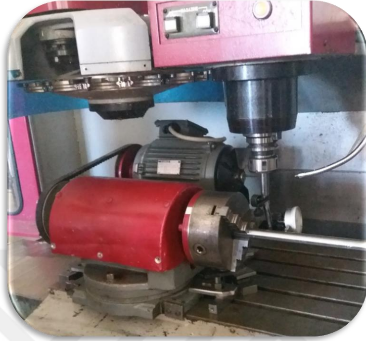
Şekil 4.4. Tornalama görevi gören düzenek
