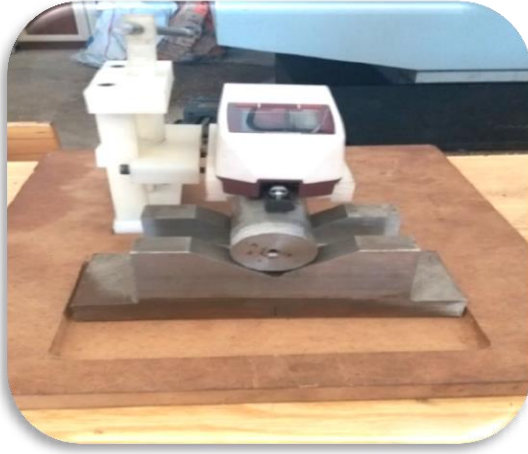
Şekil 4.7. Yüzey pürüzlülük cihazı ve ölçüm için tasarlanan düzenek
