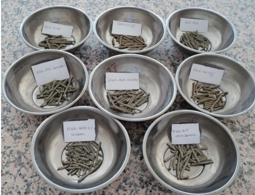
Şekil 4.48. Plastik limite ulaşmış silindirik örnekler
