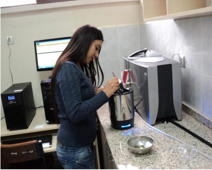
Şekil 4.24. Malvern Mastersizer 3000 Lazer Kırınım Cihazı'nda tane boyu analizleri
