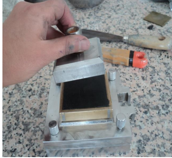
Şekil 4.76. Örneğin tıraşlanması ve kesme kutusu aparatına yerleştirilmesi
