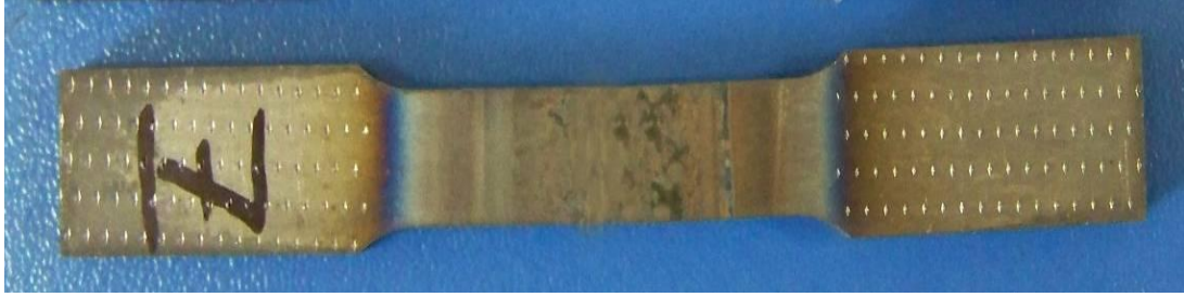
Şekil 4.8. Çekme testi deneyinde kullanılan numunelerin fotoğrafı
