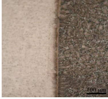
Şekil 5.26. 0.5 m/dk ilerleme hızında yapılan Ni aratabakalı birleştirmelerden Ni3 numunesinin optik görüntüleri
