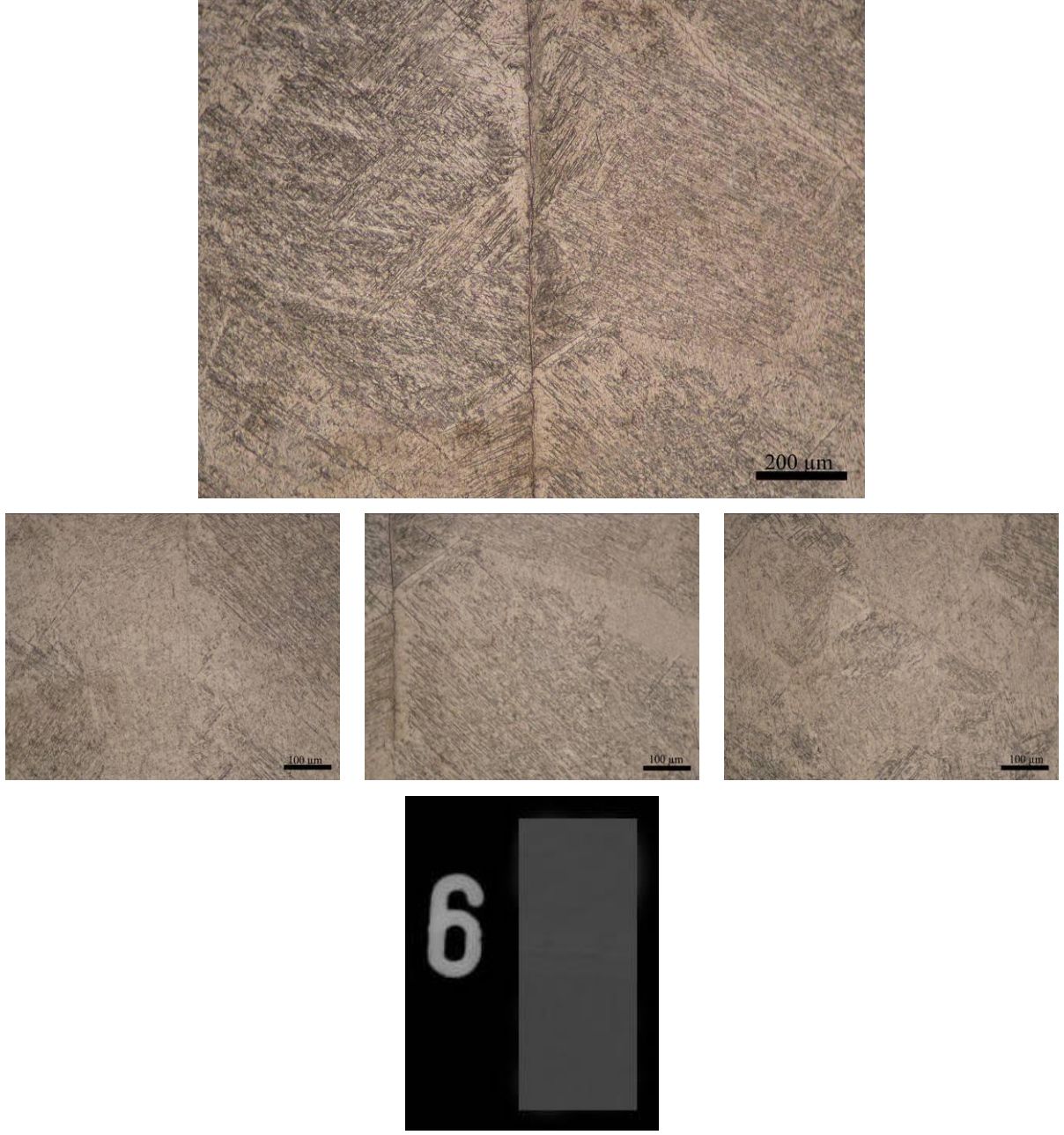
Şekil 5.21. Aratabakasız 0.5 m/dk ilerleme hızında yapılan birleştirmelerden N6 numunesinin optik görüntüleri
