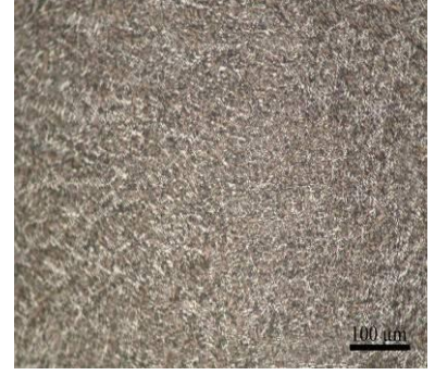
Şekil 5.26. 0.5 m/dk ilerleme hızında yapılan Ni aratabakalı birleştirmelerden Ni3 numunesinin optik görüntüleri
