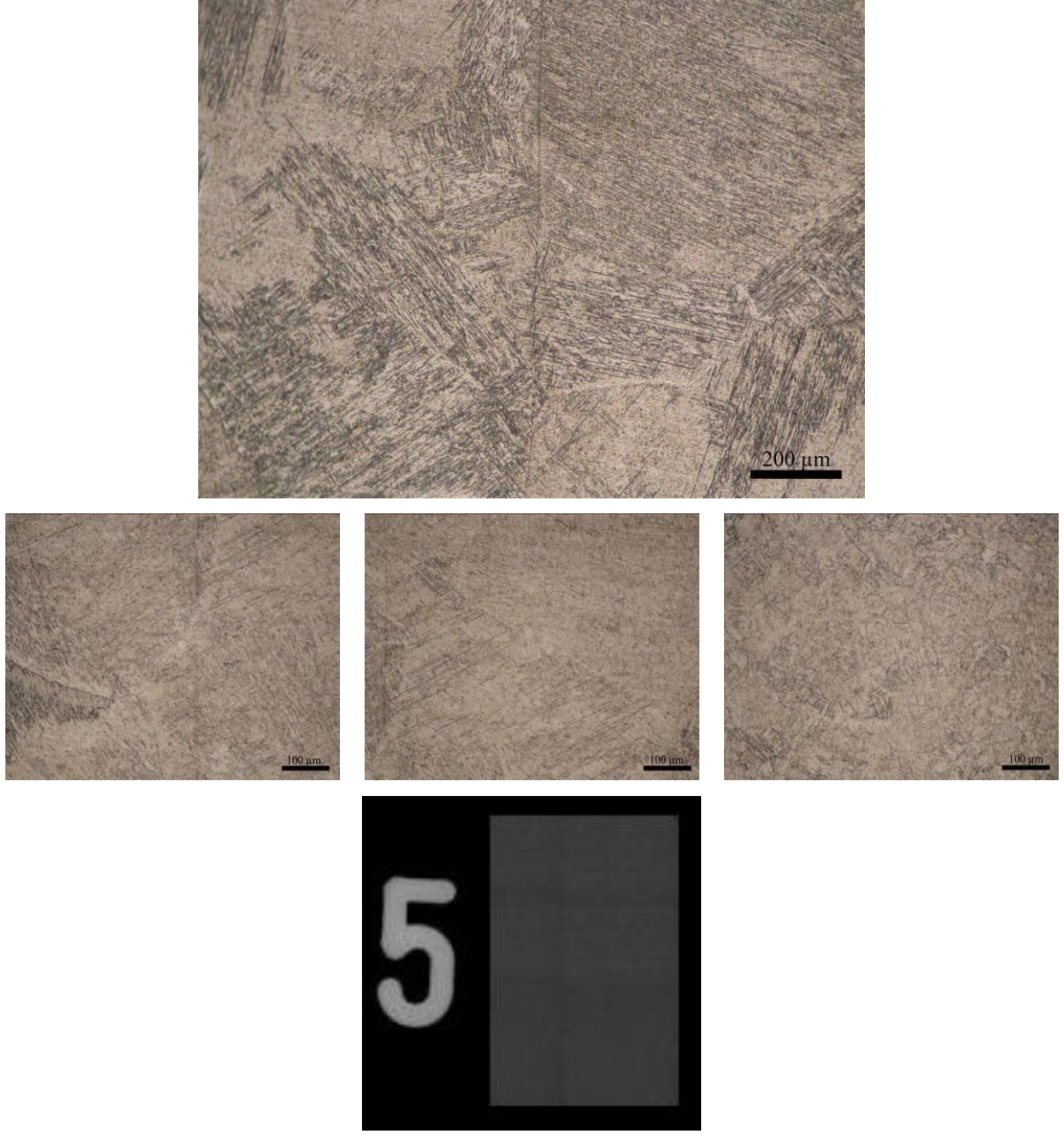
Şekil 5.12. Aratabakasız 0.75 m/dk ilerleme hızında yapılan birleştirmelerden N5 numunesinin optik görüntüleri
