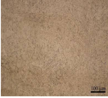
Şekil 5.26. 0.5 m/dk ilerleme hızında yapılan Ni aratabakalı birleştirmelerden Ni3 numunesinin optik görüntüleri
