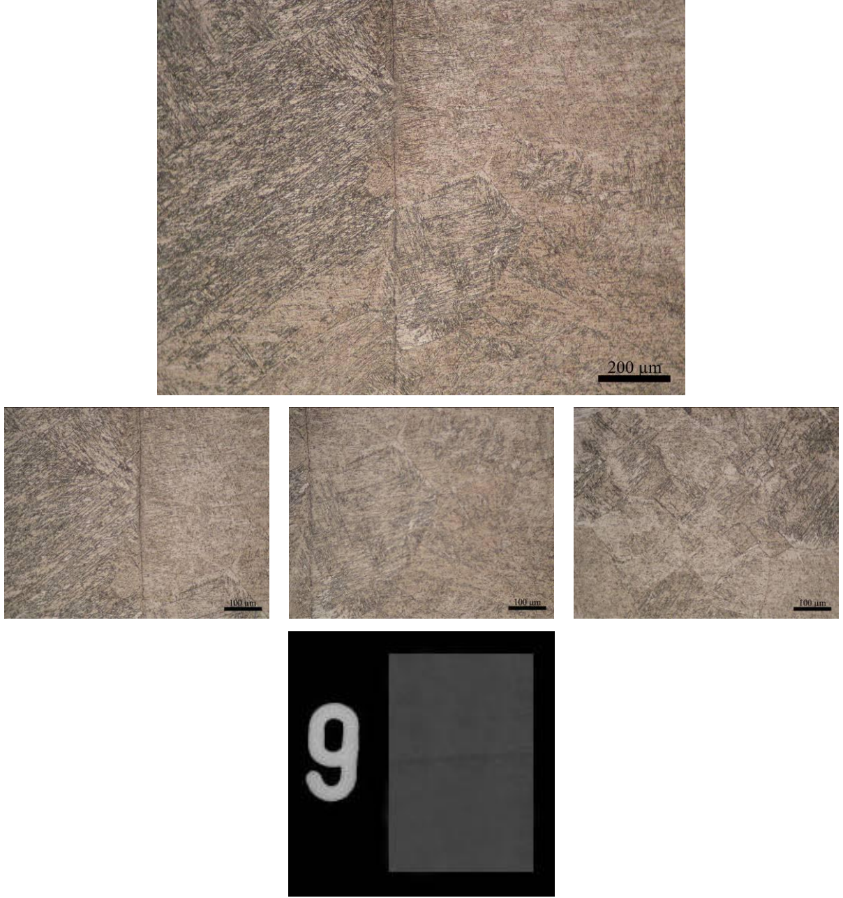
Şekil 5.22. Aratabakasız 0.5 m/dk ilerleme hızında yapılan birleştirmelerden N9 numunesinin optik görüntüleri
