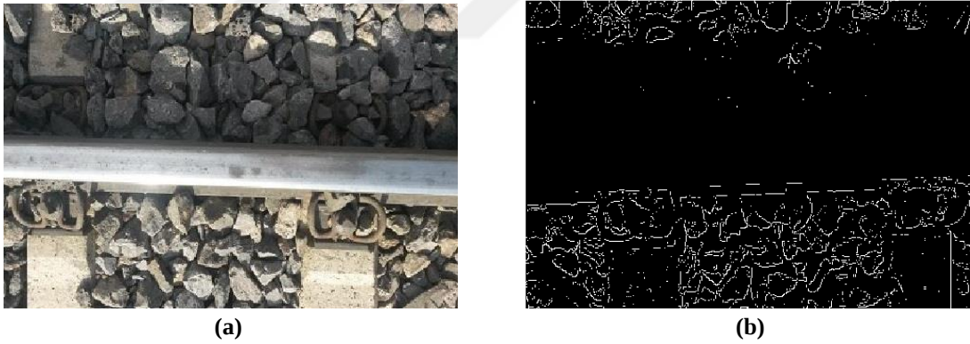
Şekil 3.4. Roberts kenar algılama algoritması sonucu (a) Normal görüntü (b) Kenar çıkarımı elde edilmiş görüntü
