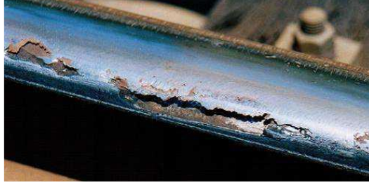
Şekil 2.22. Ray yüzeyinde oluşan kabuklanma arızası [78]
