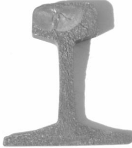
Şekil 2.27. Çapraz çatlak arızası [79]
