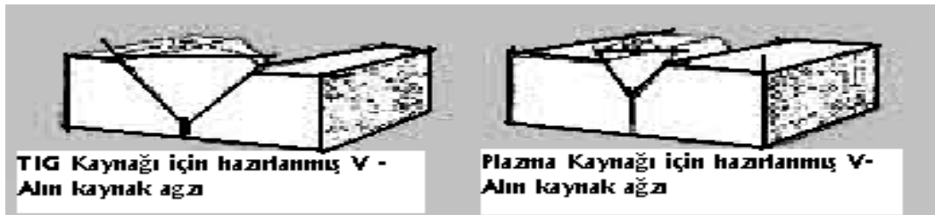
Şekil:3.2 de TIG Kaynak Yöntemi ve Plazma Kaynak Ağız Şekilleri
