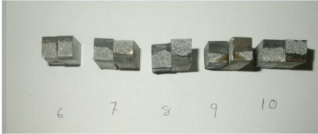
Şekil 5.45. Plazma Kaynak Yöntemiyle Kaynak Edilmiş Numunelerin Çekme Deneyi Sonrası Yüzeylerinde Oluşan Kırıkların Makro Görünüşleri
