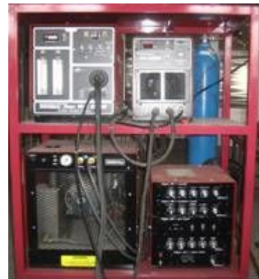
Şekil. 4.1. (a) Plazma Kaynak Makinesi Genel Görünümü ve Donanımı, (b) Kaynak ana makinesi ve kaynak konsolunun görünüşü.
