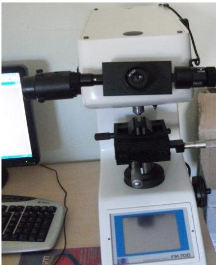
Şekil 4.9. Mikro sertlik testlerinin uygulandığı cihaz
