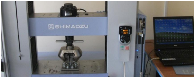
Şekil 4.6. Çekme testlerinin uygulandığı çekme cihazı
