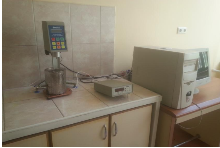
Şekil 2.5. Bitkisel yağların ve poliollerin reolojisinin incelenmesinde kullanılan düzenek
