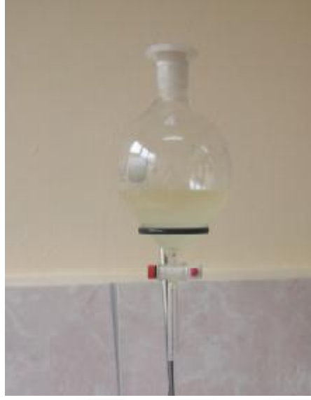
Şekil 2.2. Epoksitlenmiş bitkisel yağın ayırma hunisine alınması
