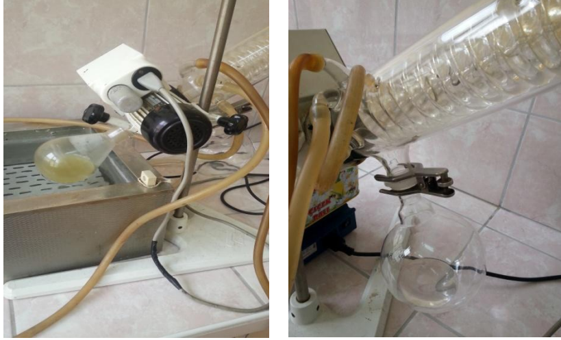
Şekil 2.3. Tepkimeye girmeyen fazla miktardaki su ve metanol'ün uzaklaştırılması
