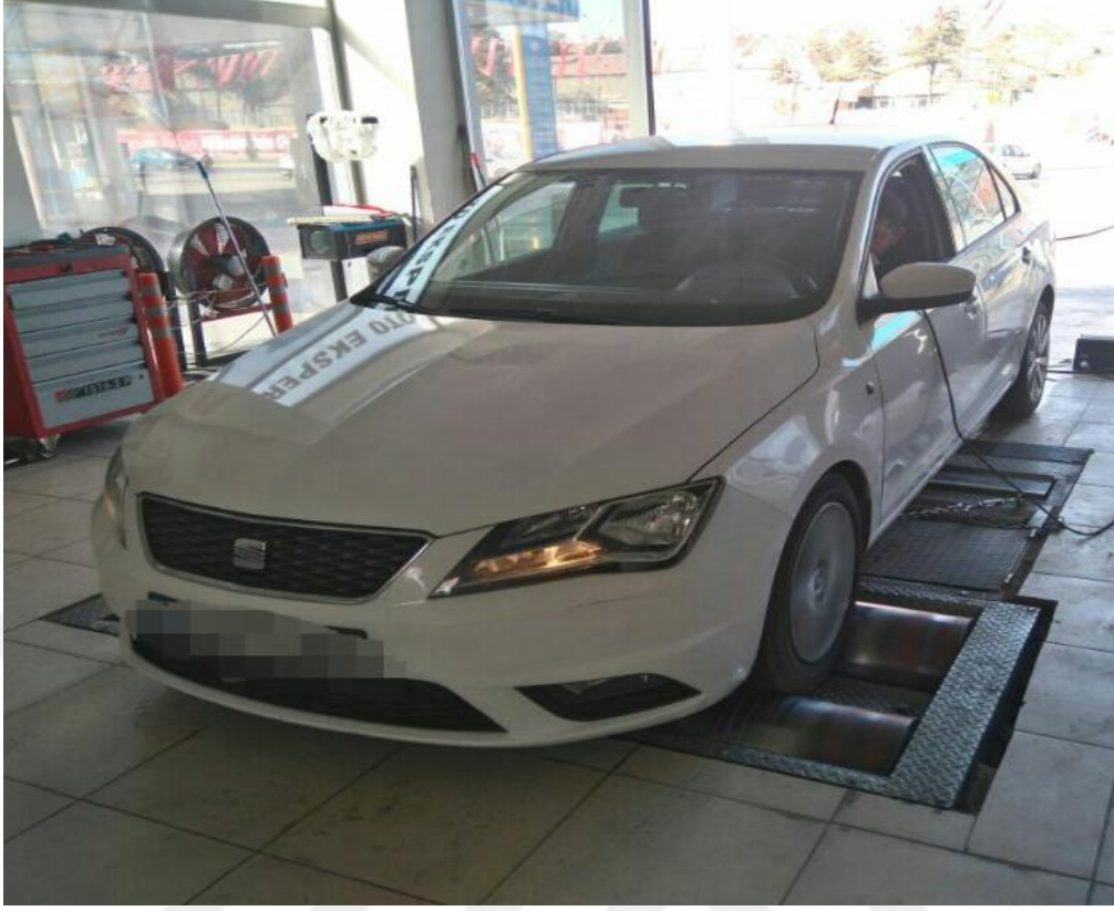
Şekil 2.1. Aracın test esnasında dinamometre üzerindeki hali
