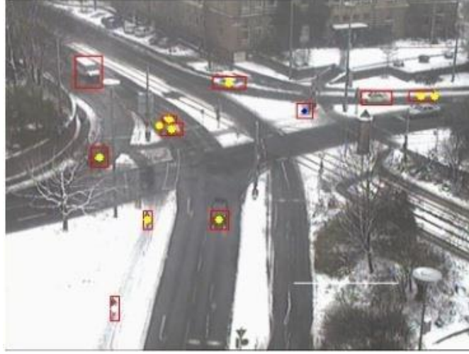
Şekil 1.3. Literatürdeki örnek bir taşıt sayma sistemi program çıktısı [24].
