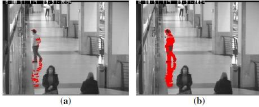
Şekil 3.14. Doku tabanlı gölge tespit algoritması için aday gölge tespiti (a) Düşük eşik değeri belirlendiğinde sahne durumu (b) Yüksek eşik değeri belirlendiğinde sahne durumu [21][38].
