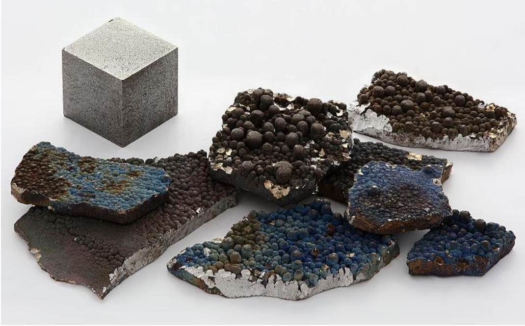
Şekil 2.2. Elektrolizle arıtılmış, %99,99 saflıkta mangan parçaları ve karşılaştırma için yüksek saflıkta (%99,99 = 4N) 1 cm 3 hacminde mangan bir küp(URL-2).
