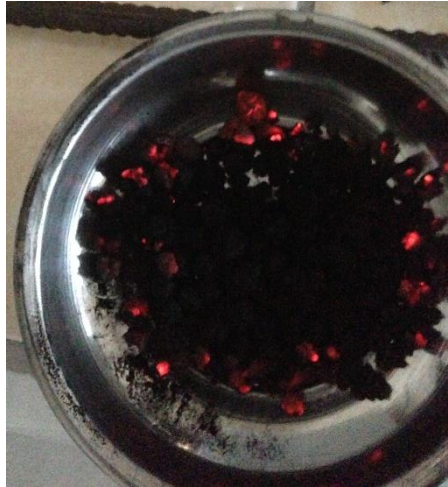
Şekil 5.5. 150 °C’ de 2 saat kurutulması denenmiş peletler
