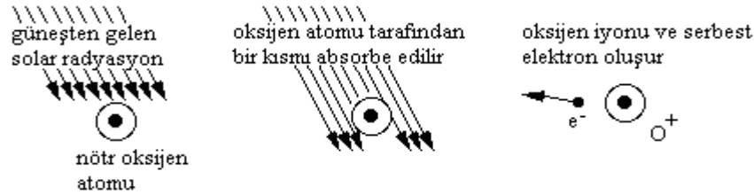
Şekil 3.2. Foto-iyonlaşma ile serbest elektron oluşumu [15]
