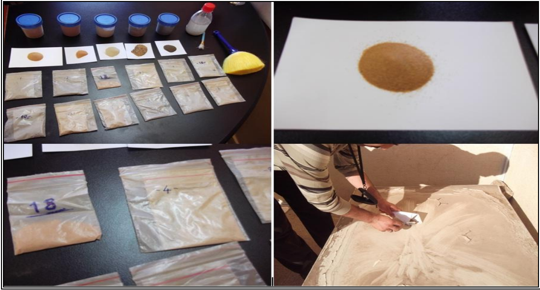
Fotoğraf 3 Çöl Tozlarının Kuru ve Yaş Çökelme örneklemeleri
