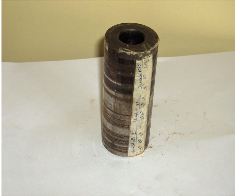
Şekil 7.66. Adhesiv aşındırıcı malzemenin aşındırmaya tabi tutulduktan sonra yüzeyinden makro çekimle alınmış fotoğrafı.
