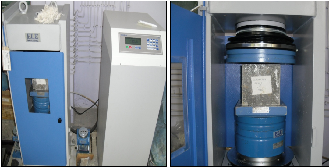
Şekil 2.5. Beton basınç dayanımı deneyi
