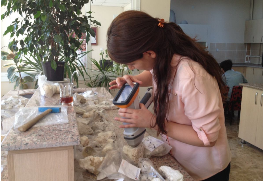
Şekil 4.1. Fırat Üniversitesi Jeoloji Mühendisliği Bölümünde portatif XRF ile alınan örneklerin major ve iz element ölçüm çalışmaları
