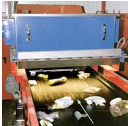
Resim 3.3 Geri dönüşüm bandı üzerinde X-ray ve manyetik seperatör ile otomatik ayrıştırma
