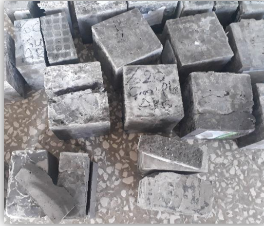
Resim 5.7 Yarmada-çekme dayanım testi uygulanmış numuneler
