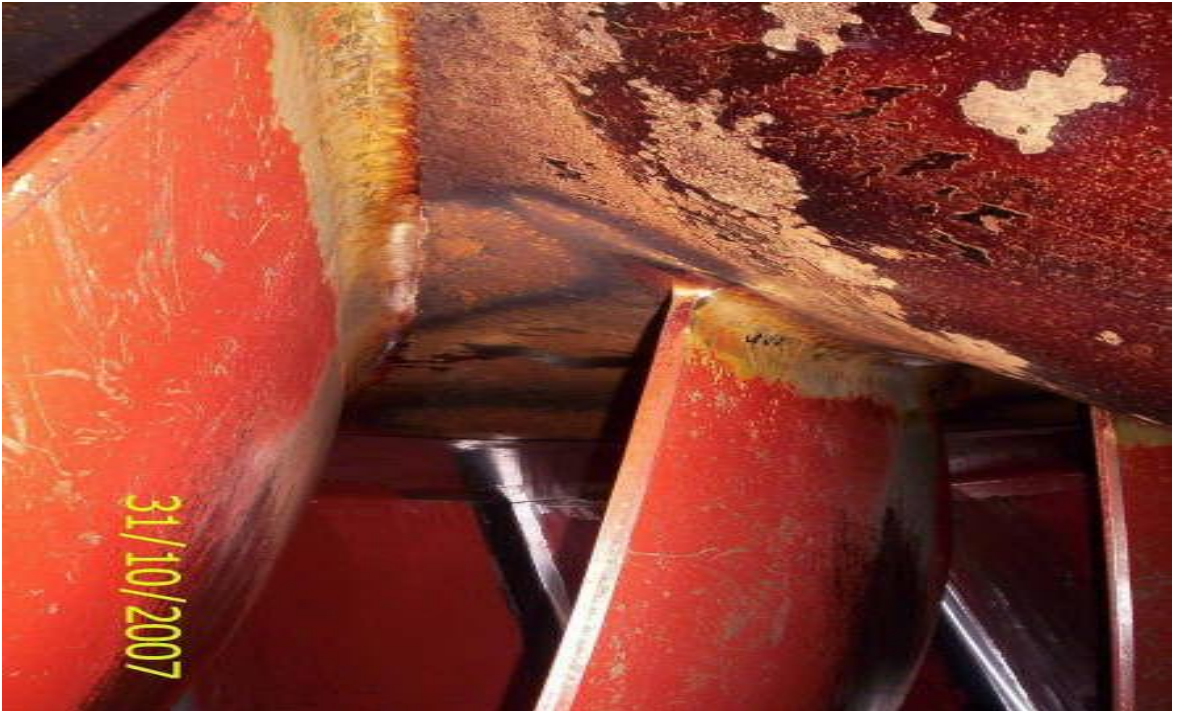
Resim 27. Atatürk HES kavitasyona uğramış türbin çark kanat aralıkları.
