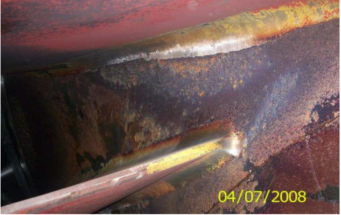
Resim 28. Atatürk HES kavitasyona uğramış türbin çark kanat aralıkları.
