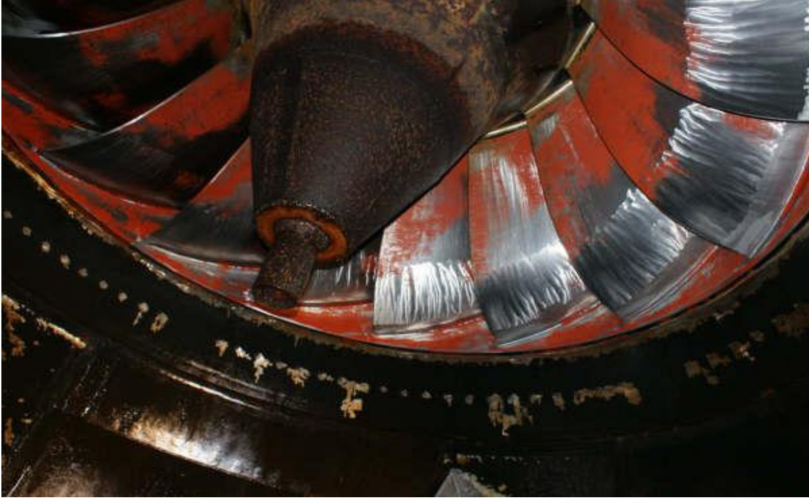
Resim 30. Atatürk HES kavitasyona uğramış türbin kepi.
