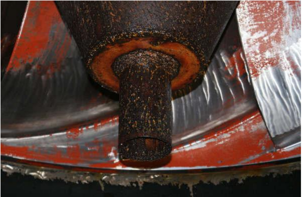
Resim 28. Atatürk HES kavitasyona uğramış türbin çark kanat aralıkları.
