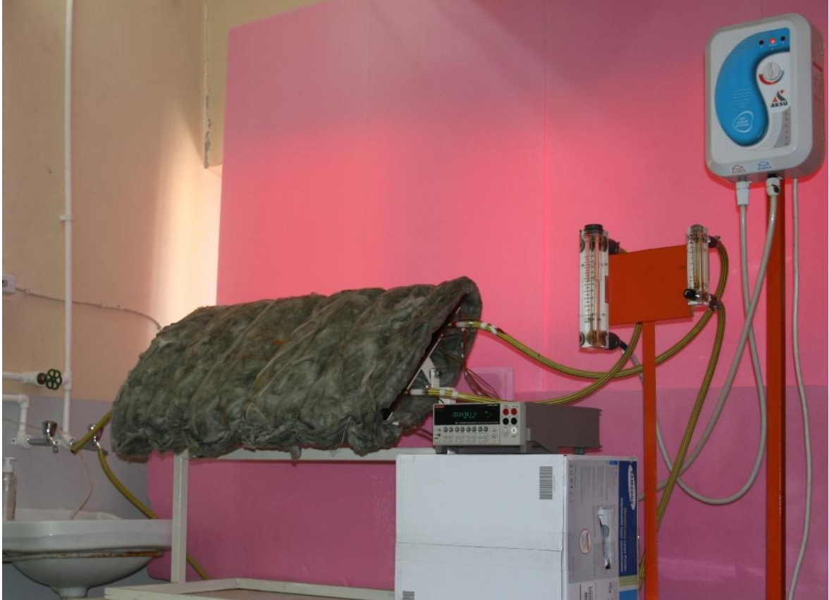
Şekil 2.11. Cam yünü ile yalıtılmış su kanalı
