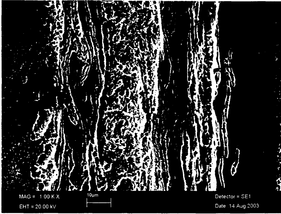
Şekil 5.23 1800 d/d'de AISI 4340 – AISI 304 kaynaklı numunenin kaynak ara bölgesi SEM fotoğrafı (Şekil 5.13.'den 4-5. bölgeler arası).
