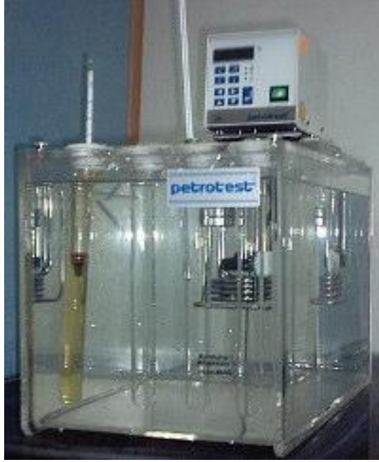
Şekil 3. 8. Yoğunluk ölçüm cihazı (petrotest) [37]
