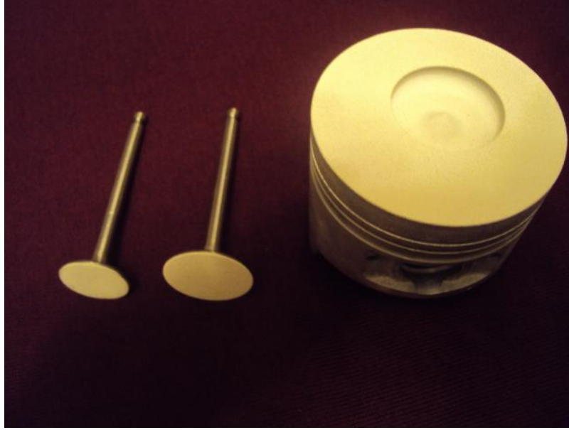
Şekil 4. 3. Motor parçalarının kaplanmış haldeki resimleri
