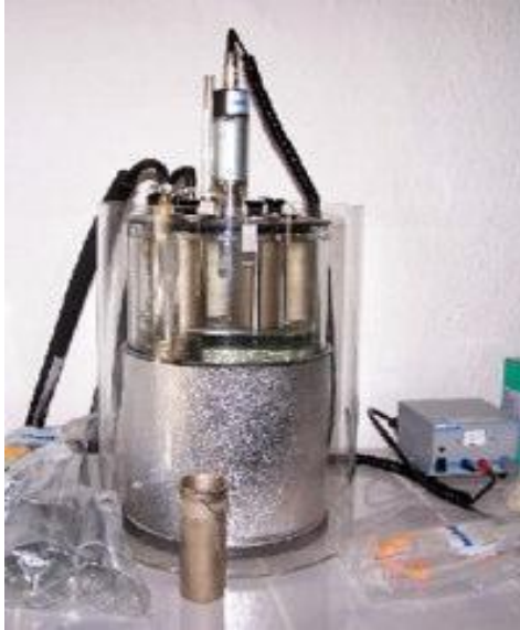
Şekil 3. 9. Akma ve Bulutlanma noktası ölçüm cihazı (Petrotest) [37].
