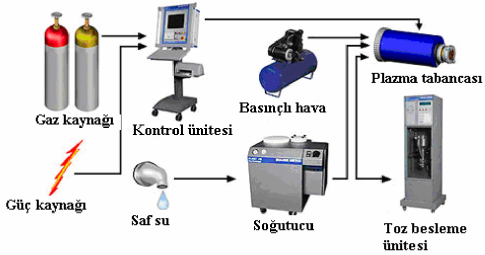
Şekil 2. 2. Plazma sprey yönteminin bileşenleri
