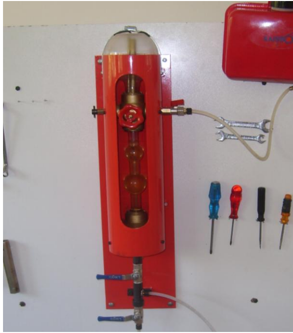
Şekil 4. 5. Yakıt tüketimi ölçüm ünitesi
