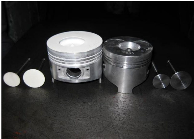
Şekil 4.2. Motor parçalarının kaplanmış ve kaplanmamış haldeki resimleri
