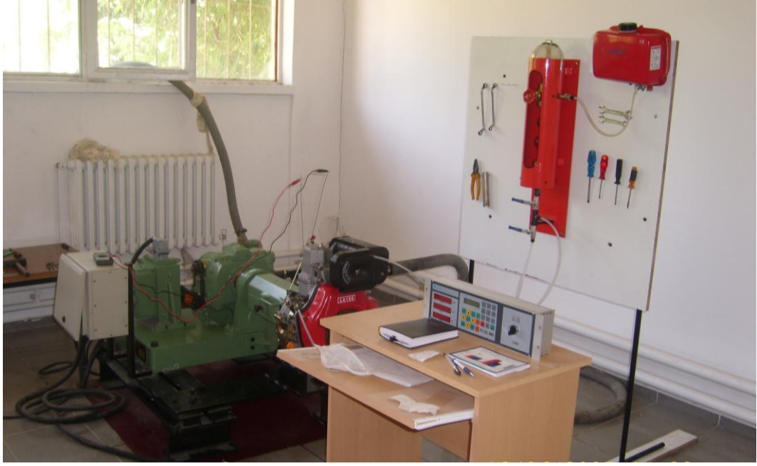
Şekil 4. 4. Deneylerde kullanılan BT–140 model hidrolik dinamometre
