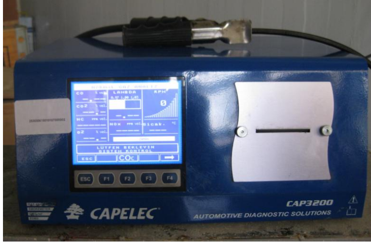
Şekil 4. 6. Gaz analiz cihazı
