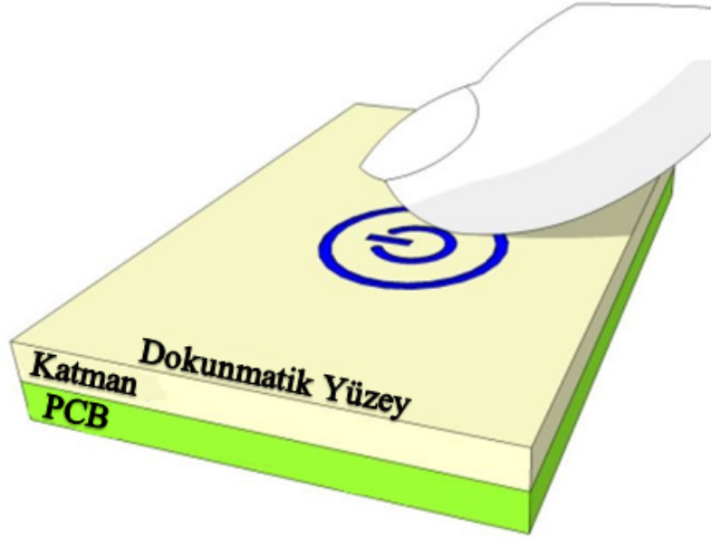
Şekil 3.1. Kapasitif sensör uygulaması
