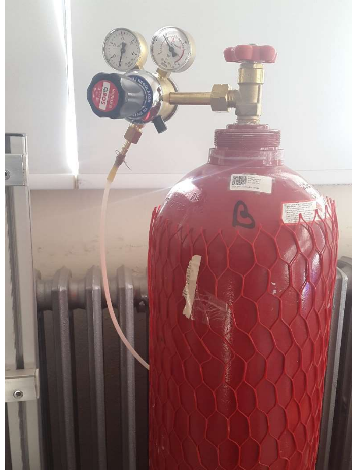
Şekil 5.6. 200 bar 50 L çelik hidrojen tüpü ve 1.5 bar çift kademeli regülatör
