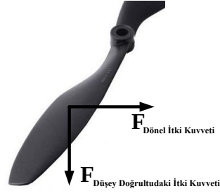
Şekil 3.1. Qaudrotorun pervanesindeki itki kuvvetleri [20].
