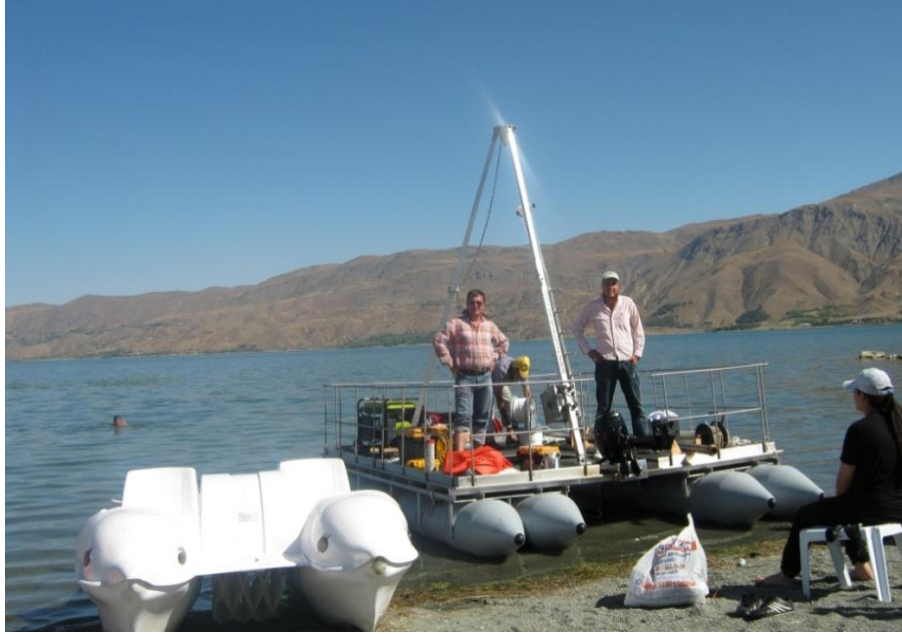
Şekil 8. Karot alımında kullanılan 3.40 mx4.40 m boyutunda yüzen platform
