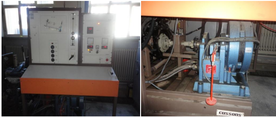
Şekil 4.4. Kumanda panosu ve Cussons P8602 marka dinamometre(bremze)
