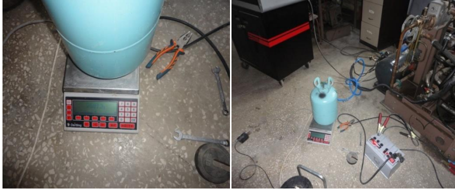
Şekil 4.6. Birim zamanda harcanan yakıt miktarı ölçülmesi
