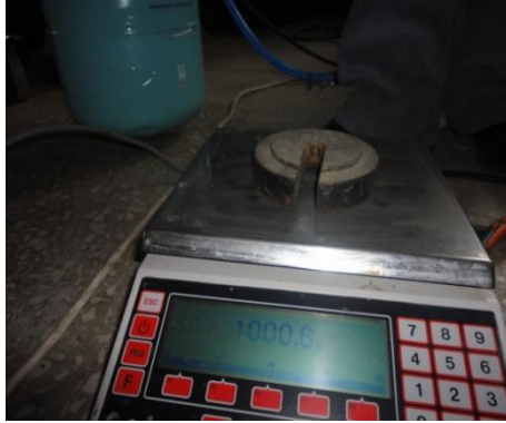
Şekil 4.7. Birim zamanda harcanan biyogaz miktarını ölçülmede kullanılan terazide güvenilirlik tespiti
