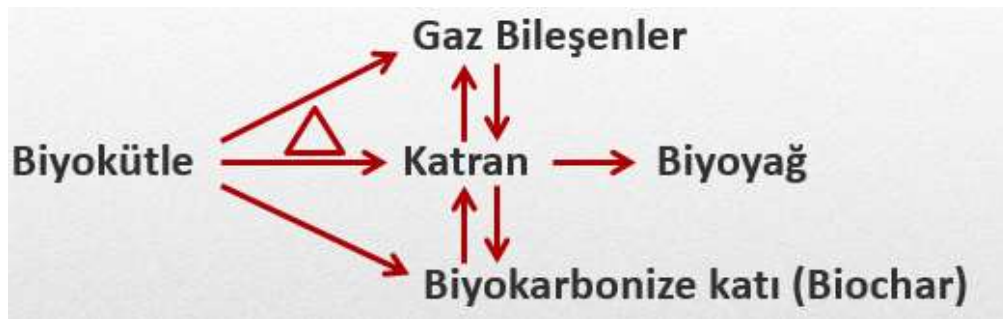
Şekil 4.3. Basitleştirilmiş piroliz reaksiyon mekanizması
