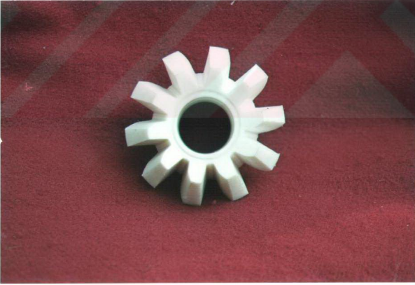
Şekil 4.8. Sağ taraf diş boşluklarının \alpha_0 açısına uygun olarak parmak freze çakısı ile kesilmiş ve işlenmiş hali.
