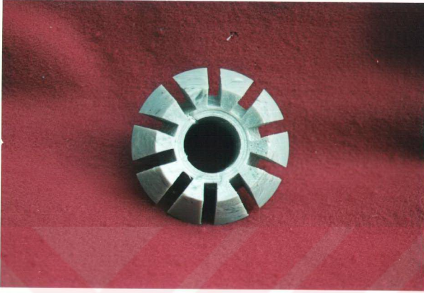
Şekil 4.4. Dış kanallarının parmak freze çakısı ile ilk açılışı.
