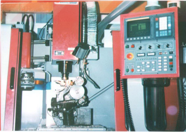
Şekil 4.10. Matterson aparatının fanuk CNC freze tezgahına bağlanması.
