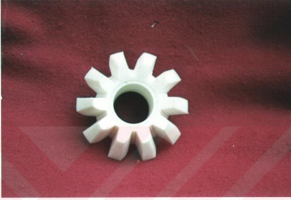
Şekil 4.6. Sol taraf diş boşluklarının \alpha_0 açısına uygun olarak parmak freze çakısı ile kesilmiş ve işlenmiş hali.
