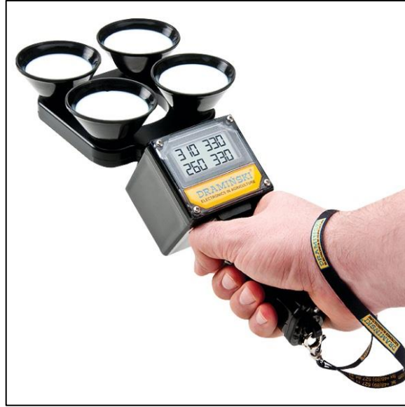
Şekil 4. Sütün elektrik direncini ölçmede kullanılan Draminski mastitis dedektörü.
